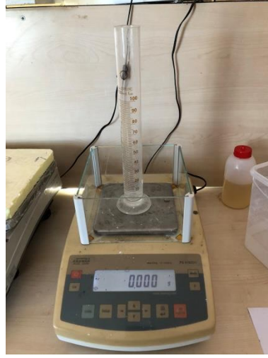
Şekil 5.5. Dereceli silindir ile genişleme oranı tayini
