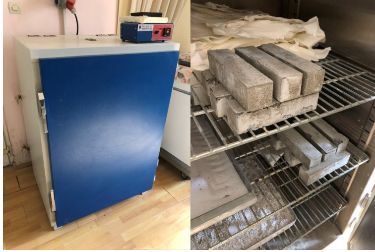
Şekil 5.9. Hava dolaşımı etüvde kurutulan numuneler
