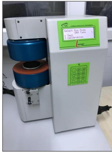
Şekil 5.13. LaserComp Fox 50 ısı iletkenlik katsayısı ölçüm cihazı
