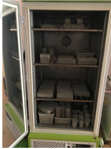
Şekil 5.6. Kalıplardan çıkarılan numunelerin iklim kabininde kürlenmesi
