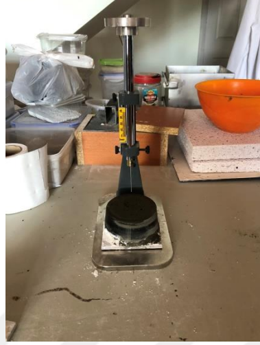
Şekil 5.2. Vicat testi ile priz süreleri tayini
