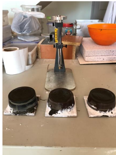
Şekil 5.7. Vicat testi uygulanmış 3 numune
