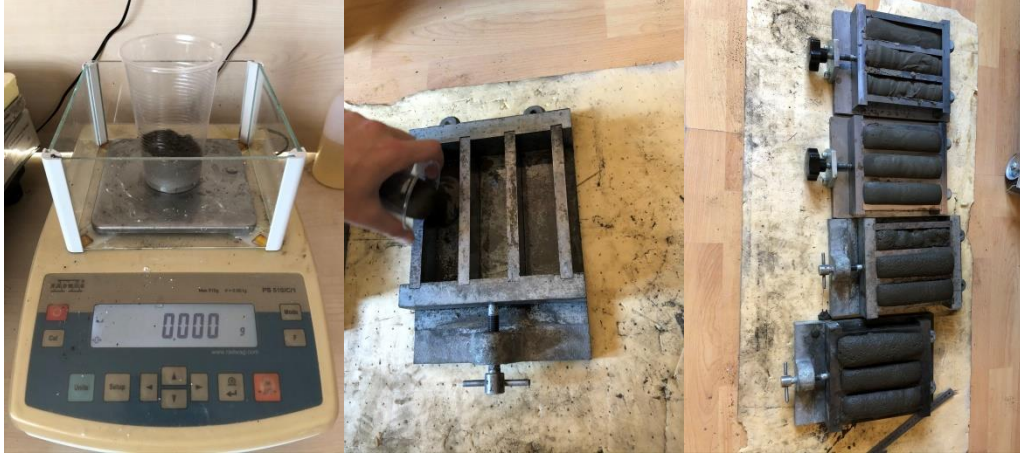
Şekil 5.3. Yöntem I ve II'ye göre üretilen numunelerin döküm işlem aşamaları
