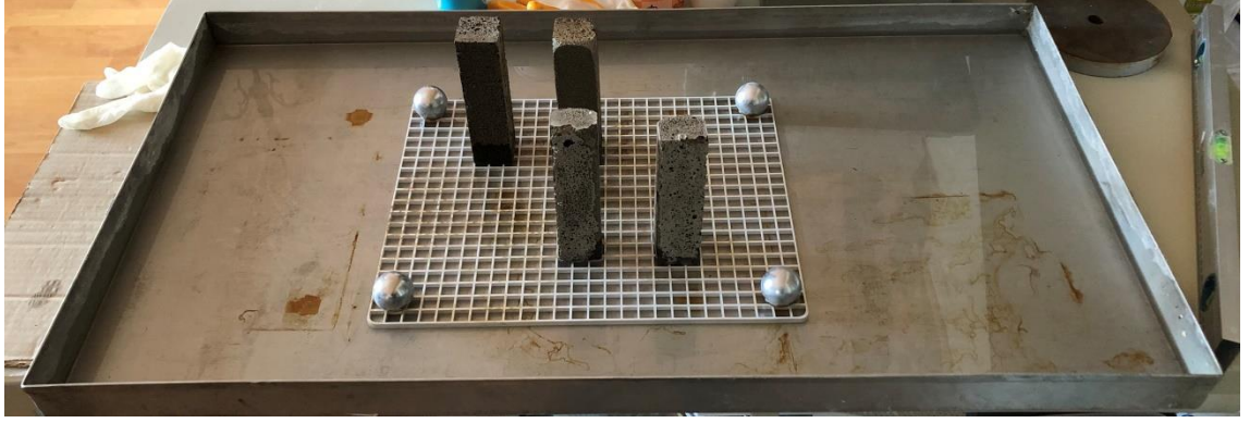
Şekil 6.42. Kılcal su emme deneyi
