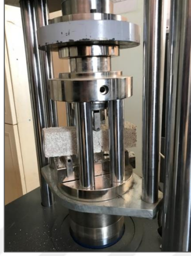
Şekil 5.11. Eğilme dayanımı deneyi
