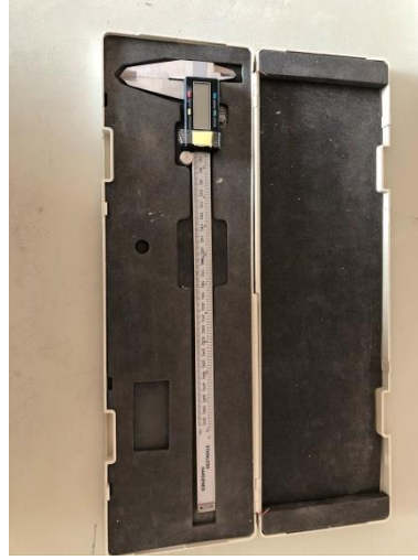
Şekil 5.10. Boyut ölçümlerinde kullanılan 0.01 mm hassasiyetli elektronik kumpas
