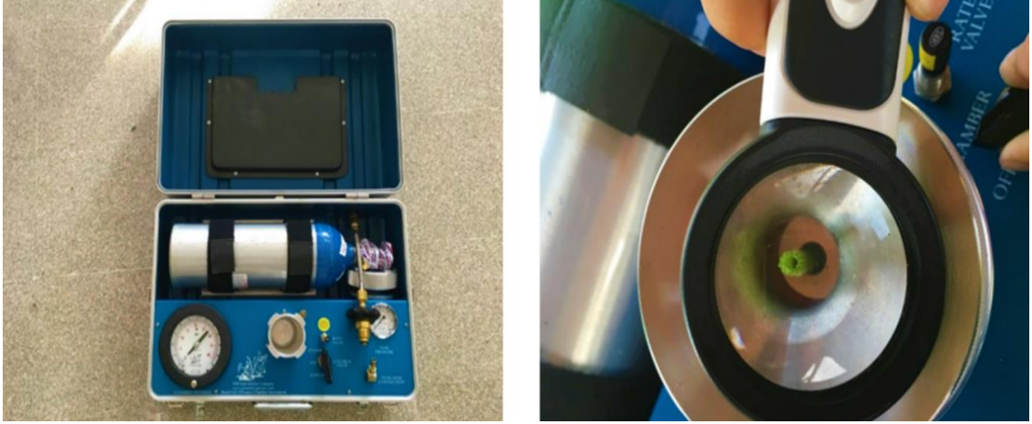
Şekil 3.11. Yaprak su potansiyeli ölçümünde kullanılan basınç odası aleti
