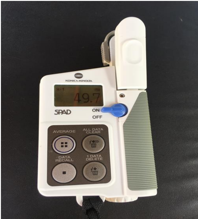
Şekil 3.12. Klorofil ölçümünde kullanılan klorofilmetre aleti
