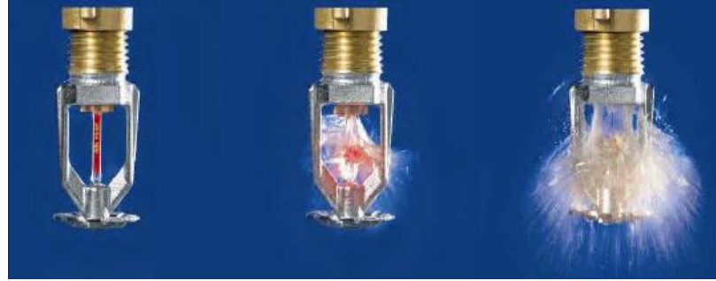
Şekil 5. 2: Sprinkler cihazı ve çalışma sistemi [27].
