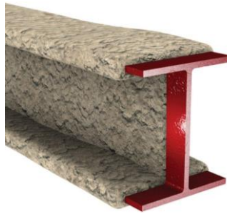
Şekil 5. 3: Şişen boyaların uygulama katmanları ile ısı etkisindeki davranışı [32].
