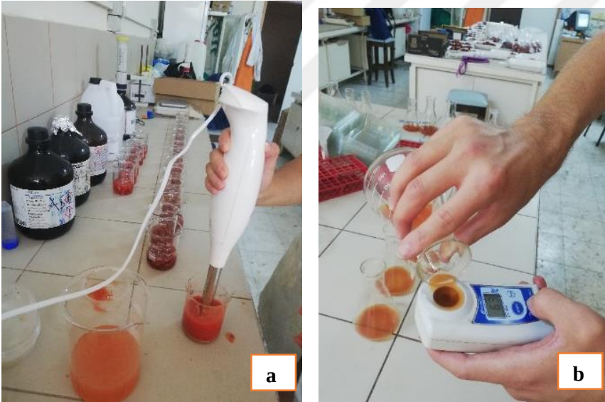
Şekil 3.24. Analiz için örneklerin hazırlanması (a) ve refraktometre ile SÇKM (briks) değerinin belirlenmesi (b).
