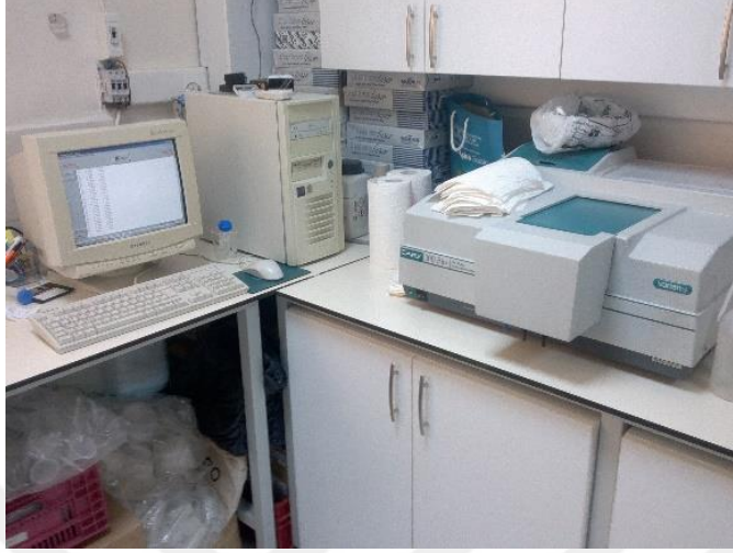
Şekil 3.20. Toplam fenol miktarı ve antioksidan aktivitesinin belirlenmesinde kullanılan spektrofotometre
