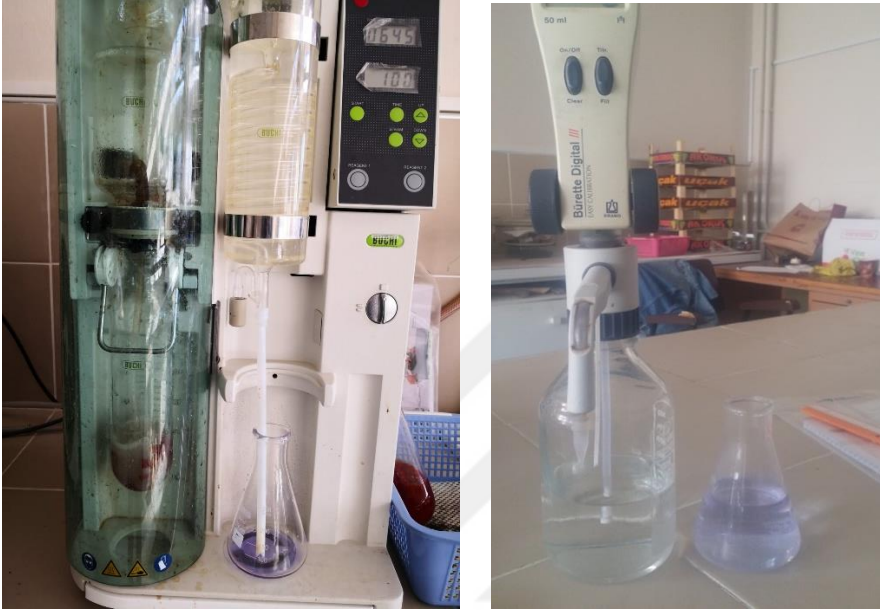
Şekil 3.25. Kükürt dioksit miktar tayini ve NaOH çözeltisi ile sarfiyat tayini.
