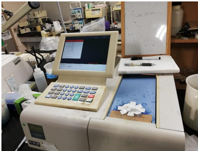
Şekil 3.26. Kuru domateslerde toplam fenol miktarı ve antioksidan aktivitesinin belirlenmesinde kullanılan spektrofotometre.
