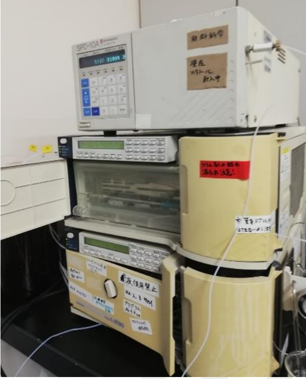
Şekil 3.28. Kuru domateslerde likopen miktarının belirlenmesinde kullanılan HPLC cihazı.
