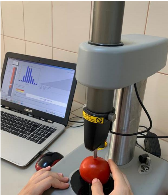
Şekil 3.18. Domates meyvelerinin sertlik ölçümü
