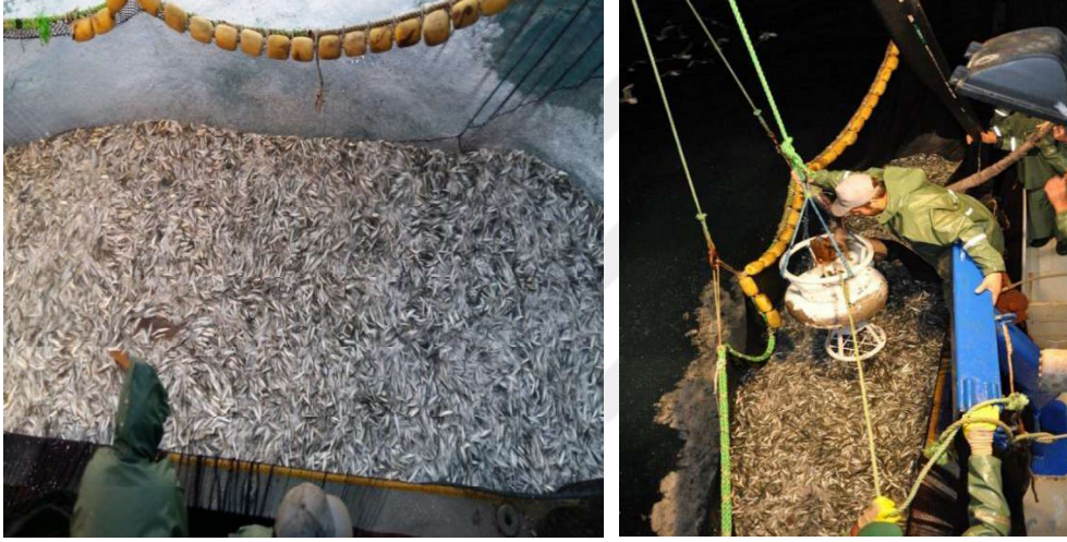
Şekil 2.5. Bocilikte sıkıştırılan balık ve balık pompası.
