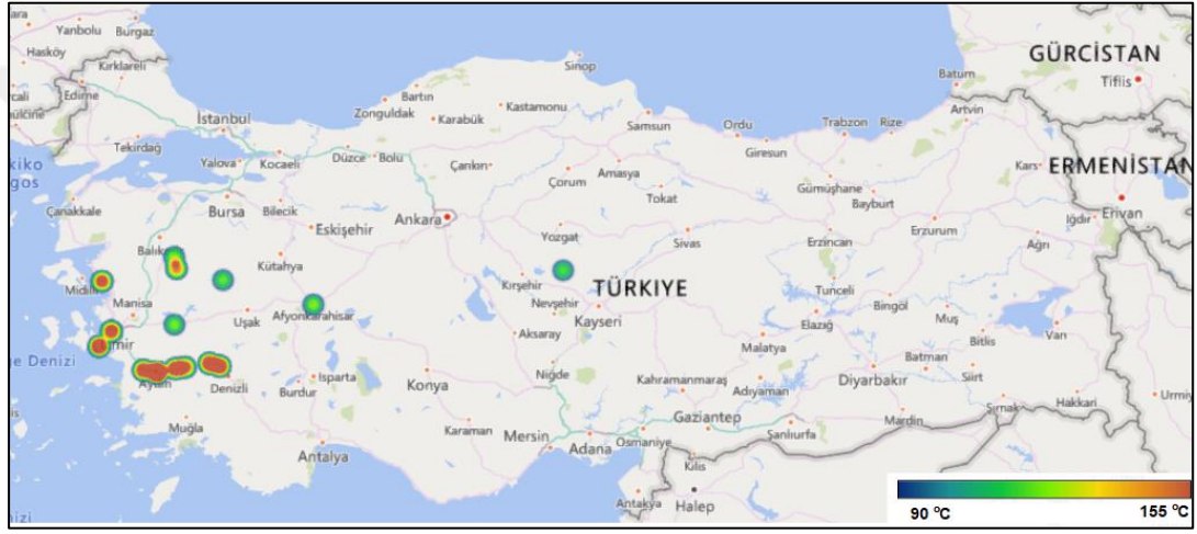
Şekil 4.71: Türkiye'deki orta sıcaklıklı jeotermal enerji kaynaklarının dağılımı.
