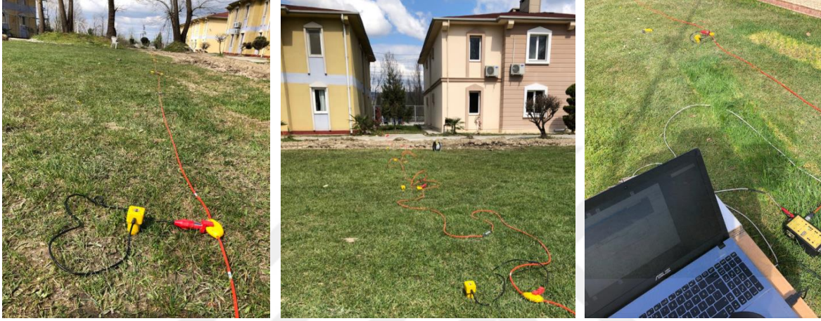
Şekil 3.2: Sismik Kırılma, MASW arazi deneyleri yapılışı (Anon., 2019).
