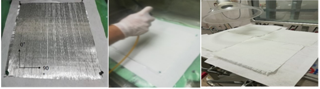
Şekil 5.4. Püskürtme işlemi ile elyaf yüzeylerin h-BN ile kaplanması
