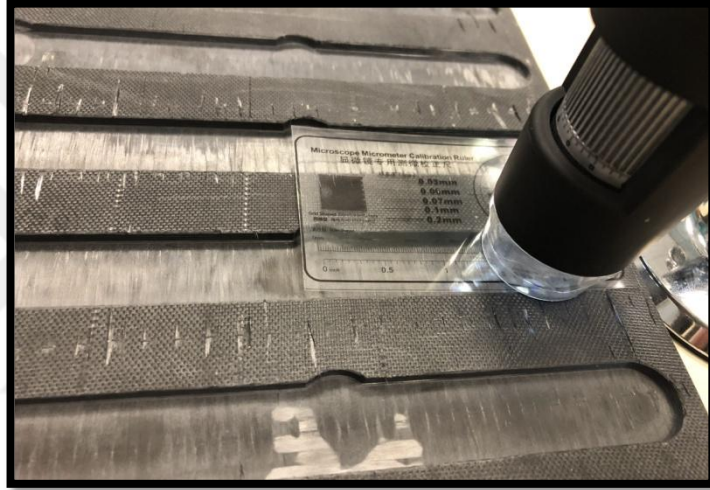
Şekil 3.43: Parça üzerindeki deformasyonların kalibrasyon eki ile tespit edilmesi
