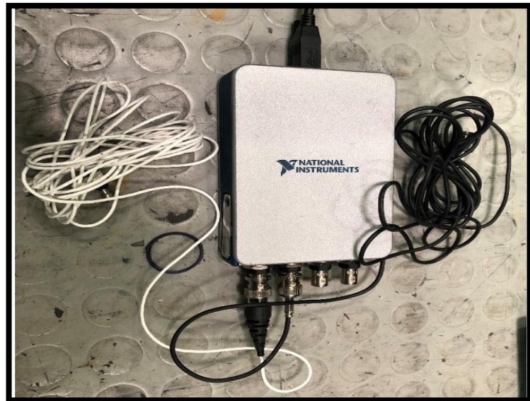
Şekil 3.33: Çekiç testi NI9234 modülü, ivme ve kuvvet ölçme ekipmanları
