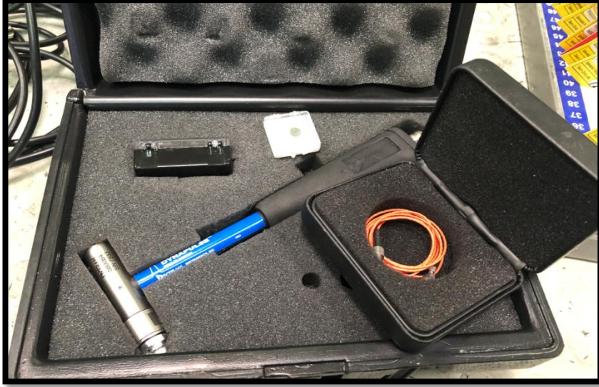
Şekil 3.34: İvme ölçer ve çekiç ekipmanları
