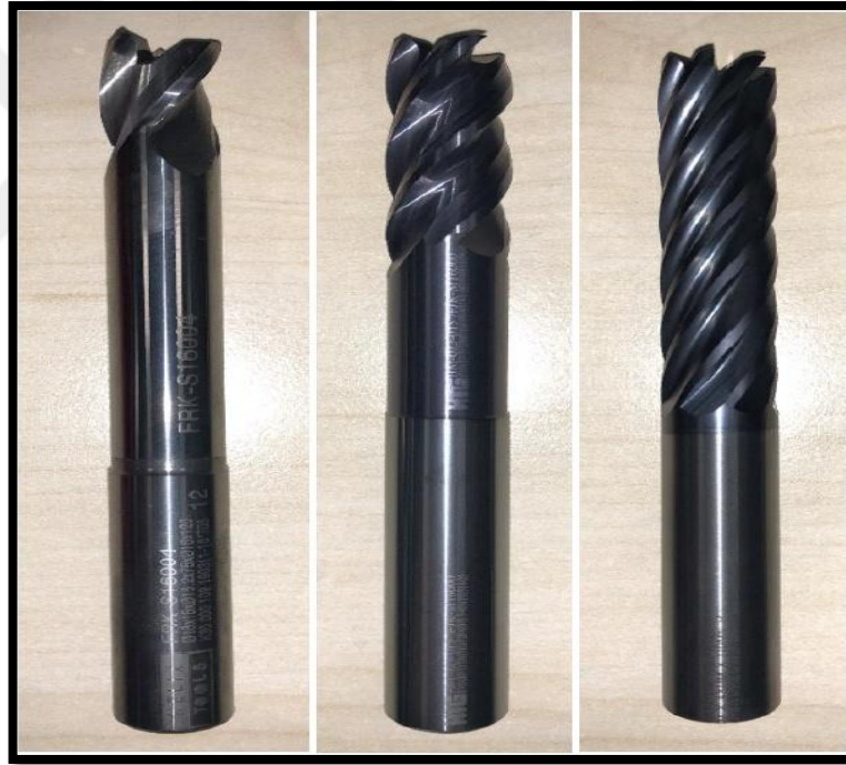
Şekil 3.10: 3 ağızlı, 4 ağızlı Ti-Al ve 7 ağızlı Ti-Al karbür freze
