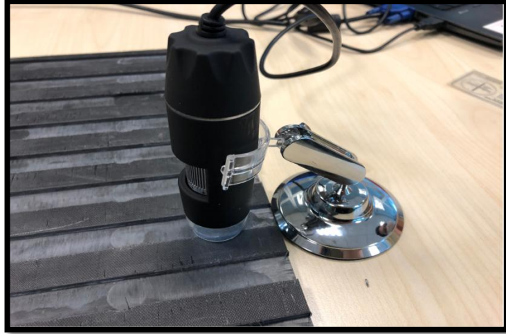
Şekil 3.42: Parça üzerindeki deformasyonların ölçümünün yapılması
