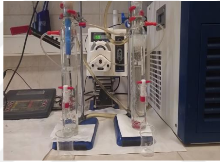
Resim 3.5: Çok damlacıklı sıvı membran sistemi (ÇDSMS).
