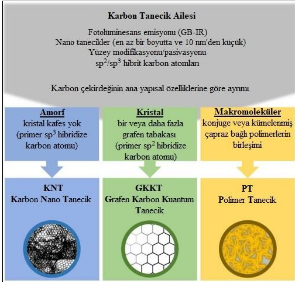
Şekil 2.1. Üç ana tipteki karbon taneciğin şematik gösterimi
