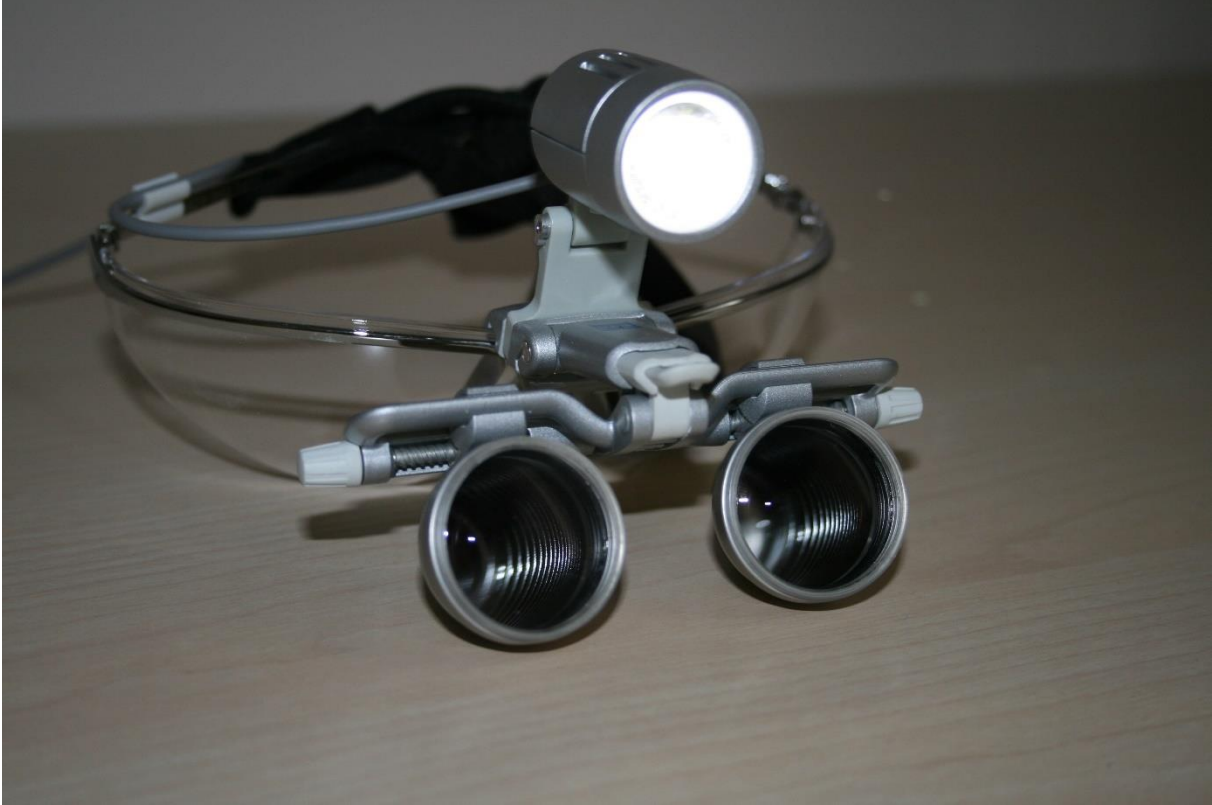
Resim 7: Zeiss Eyemag Smart 2,5 büyütmeli büyüteç ve Zeiss Eyemag Light II kafa aydınlatması
