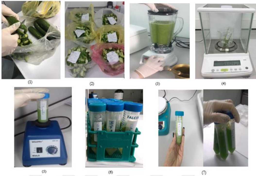
Şekil 12. Örnek doğrama (1), doğranmış örnekler (2), blenderda homojenizasyon (3), homojenize edilmiş örnekten 15 g analitik porsiyon (AP) alma (4), vorteksleme işlemi (5), ekstrakte edilmiş örnekler (6) ve santrifüj öncesi falkon tüp örneği (7)
