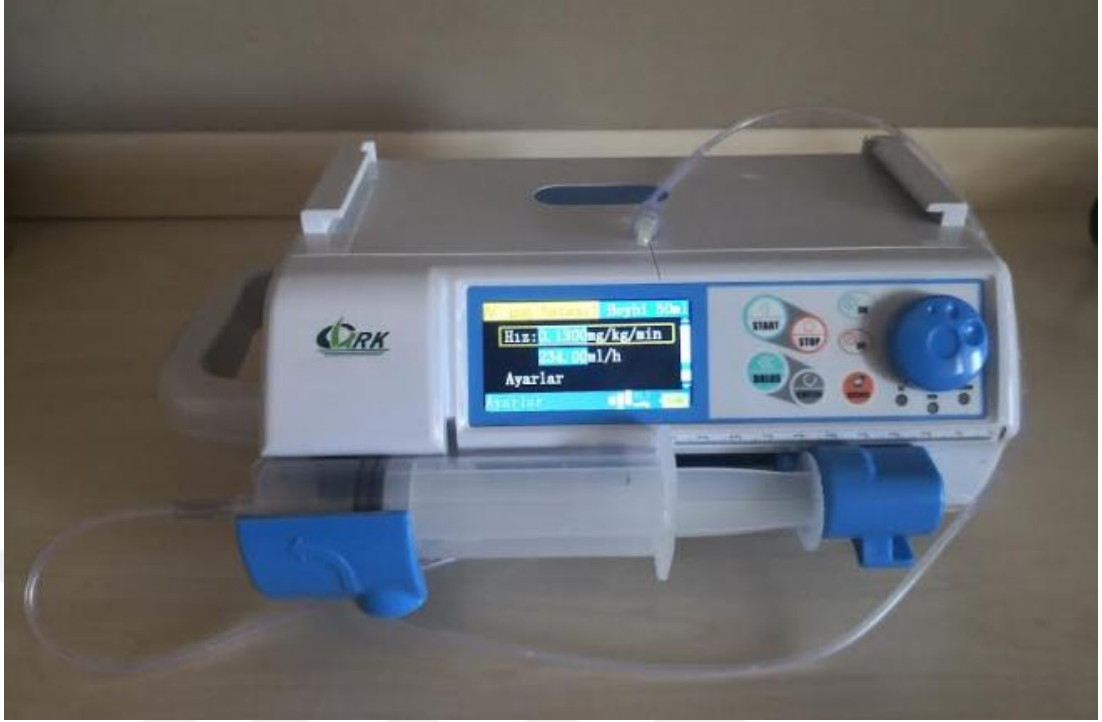
Şekil 2.3.3. İrrigasyon esnasında solüsyonun sabit akış hızında verilebilmesi için kullanılan şırıngalı infüzyon pompası
