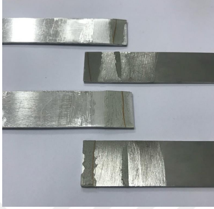
Şekil 3.22: 0,2 mm kalınlıkla oluşturulan bağlantının çekme deneyi sonu
