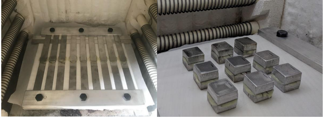
Şekil 3.12: Isıl işlem fırınına yerleştirilmiş tabla üzerinde yapıştırılmış numuneler
