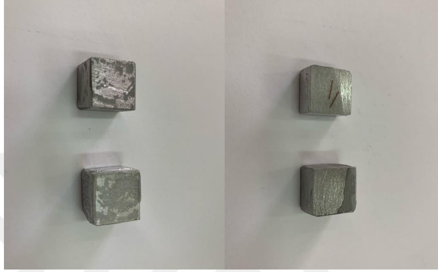
Şekil 3.27: İzod darbe deneyi sonu
