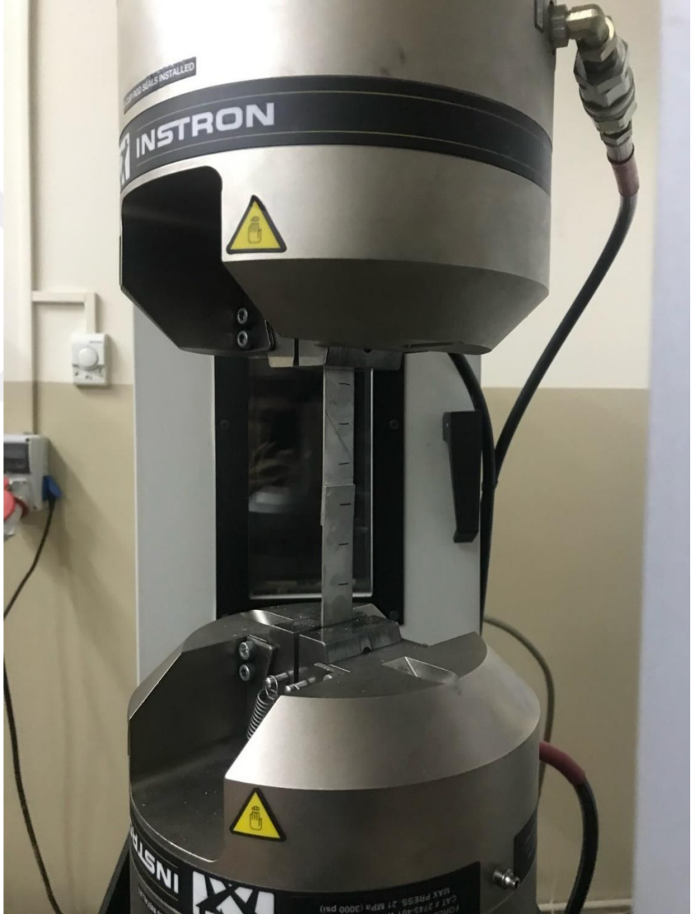
Şekil 3.20: Çekme cihazına bağlanmış numune
