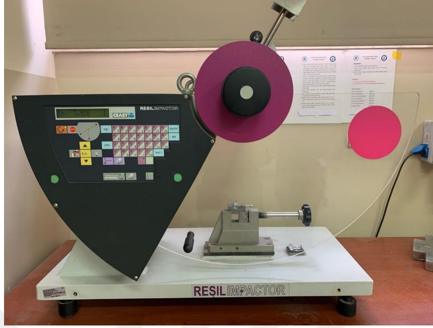
Şekil 3.25: 25 J kapasiteli Instron Ceast izod darbe deney cihazı
