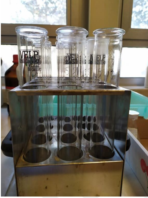
Şekil 29. Kjeldahl yönteminde yakma tüplerine örneklerin koyulması ve yakma ünitesine yerleştirilmesi
