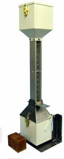
řekil 18. Kolza tohumu ile ekmek hacminin belirlenmesi
