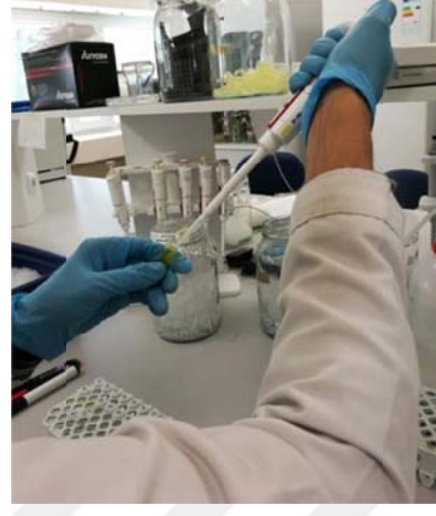
Şekil 3.3. Kloroform isoamyl alkol eklenmesinin ardından üst faz görüntüsü ve fazın yeni tüp içine aktarımı
