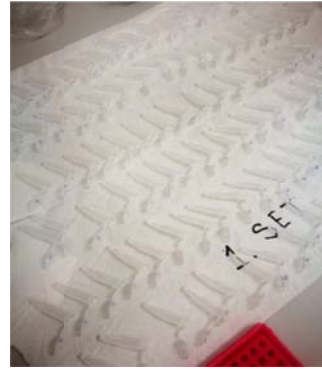
Şekil 3.4. İzopropanol eklenerek elde edilen DNA örneği ve üst faz dökülerek kurutmaya bırakılan tüpler
