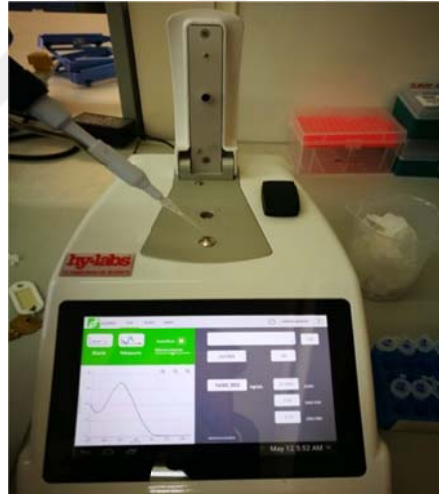
Şekil 3.5. DNA örneklerinin kantitatif miktarı ve kalitesi DeNovix DS-11 FX Spectrophotometer/Fluorometer cihazı ile ölçülmesi.
