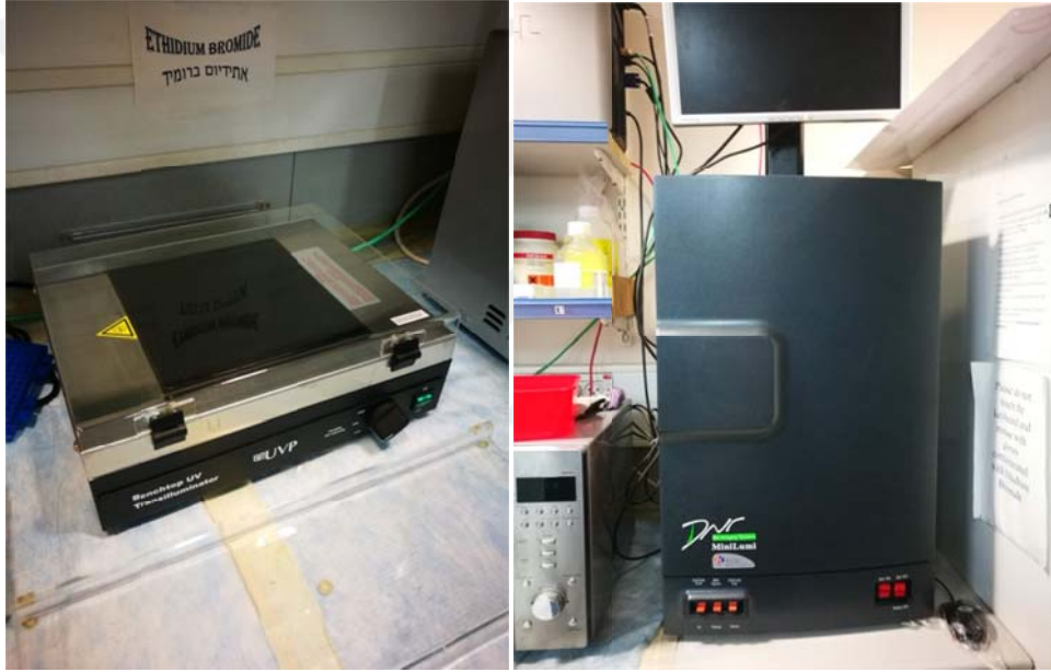
Şekil 3.6. DNA örneklerinin kalitatif analizi için kullanılan transilluminatör ve ultraviyale jel dökümantasyon sistemi
