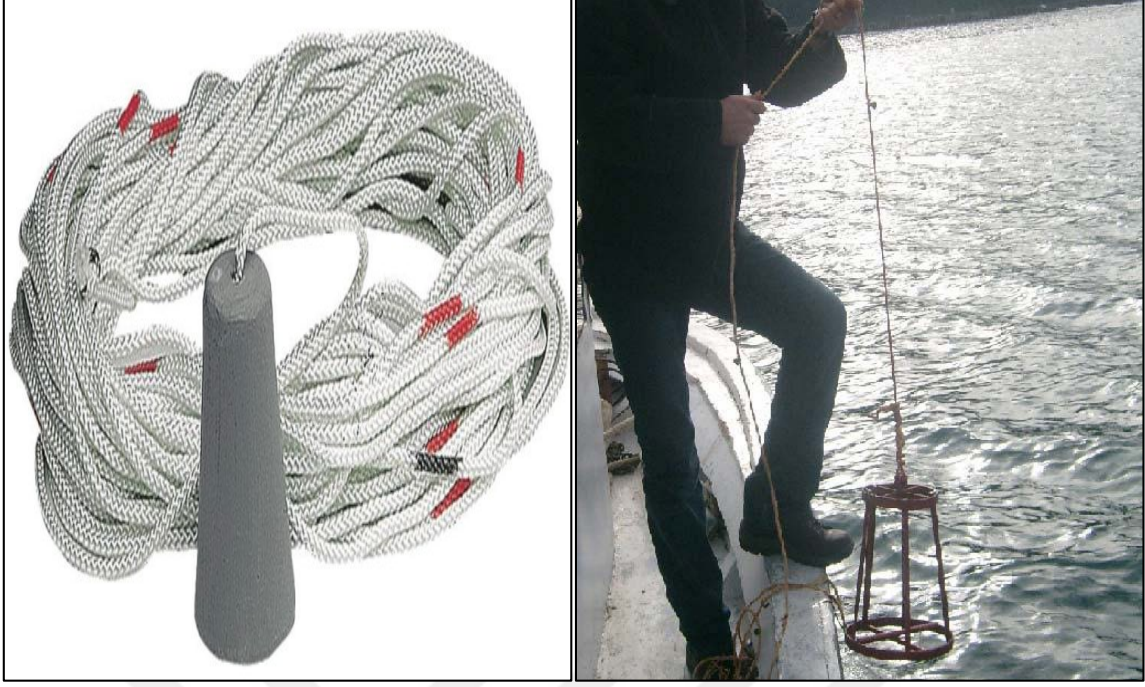
Şekil 2.5 İpli İskandil Yöntemi (URL 6).
