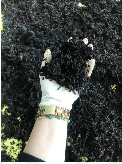
Şekil 3.2: Fıstık fabrikasyon atığının biyokömür formu
