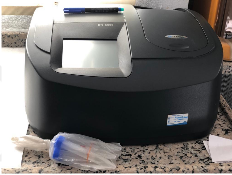
Şekil 3.20. Spektrofotometrede 880 nm dalga boyunda okunması.
