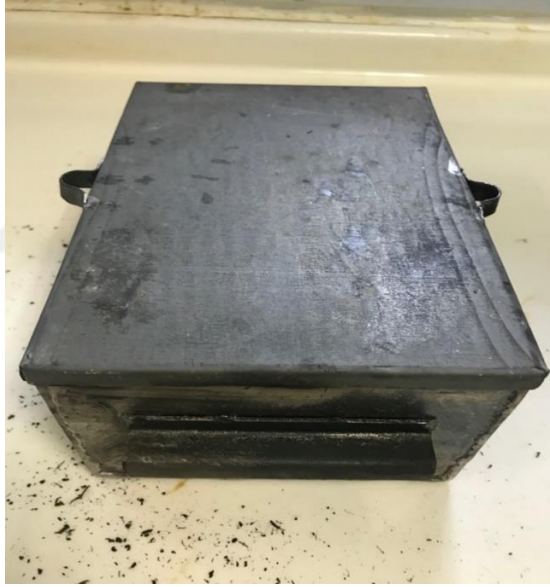
Şekil 3.5. Galvanizli Sac Piroliz Ünitesi
