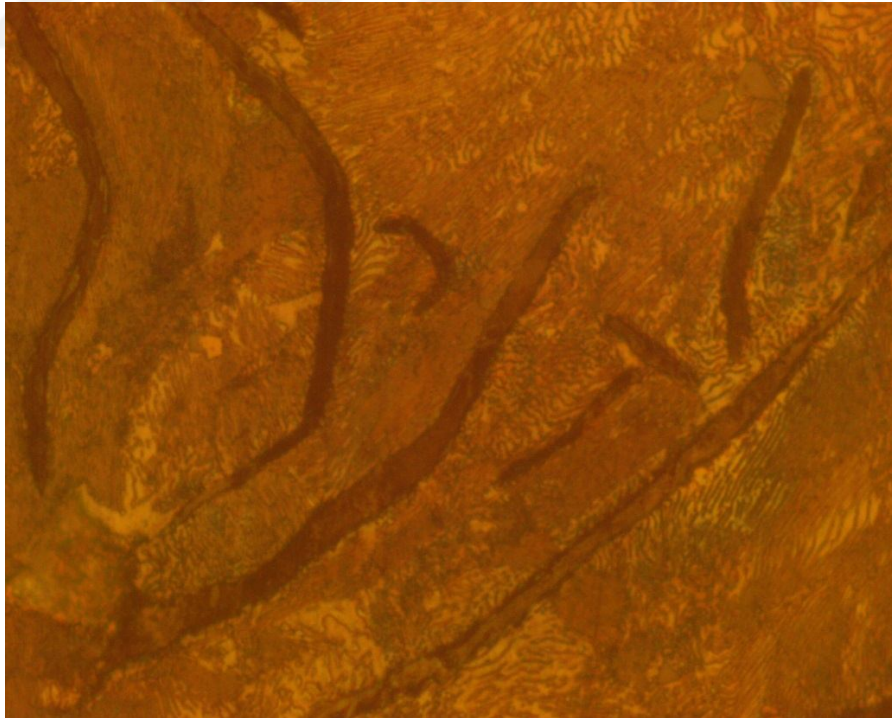
Şekil 5.4. 1 nolu Fe-Si numunesine ait dađlanmıř 200X grnts
