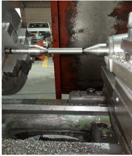
Şekil 4.18. Darbe testi numunesinin CNC tezgahında işlenmesi
