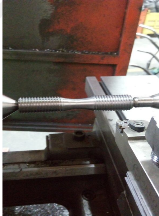
Şekil 4.17. Çekme testi numunesinin torna tezgahında işlenmesi
