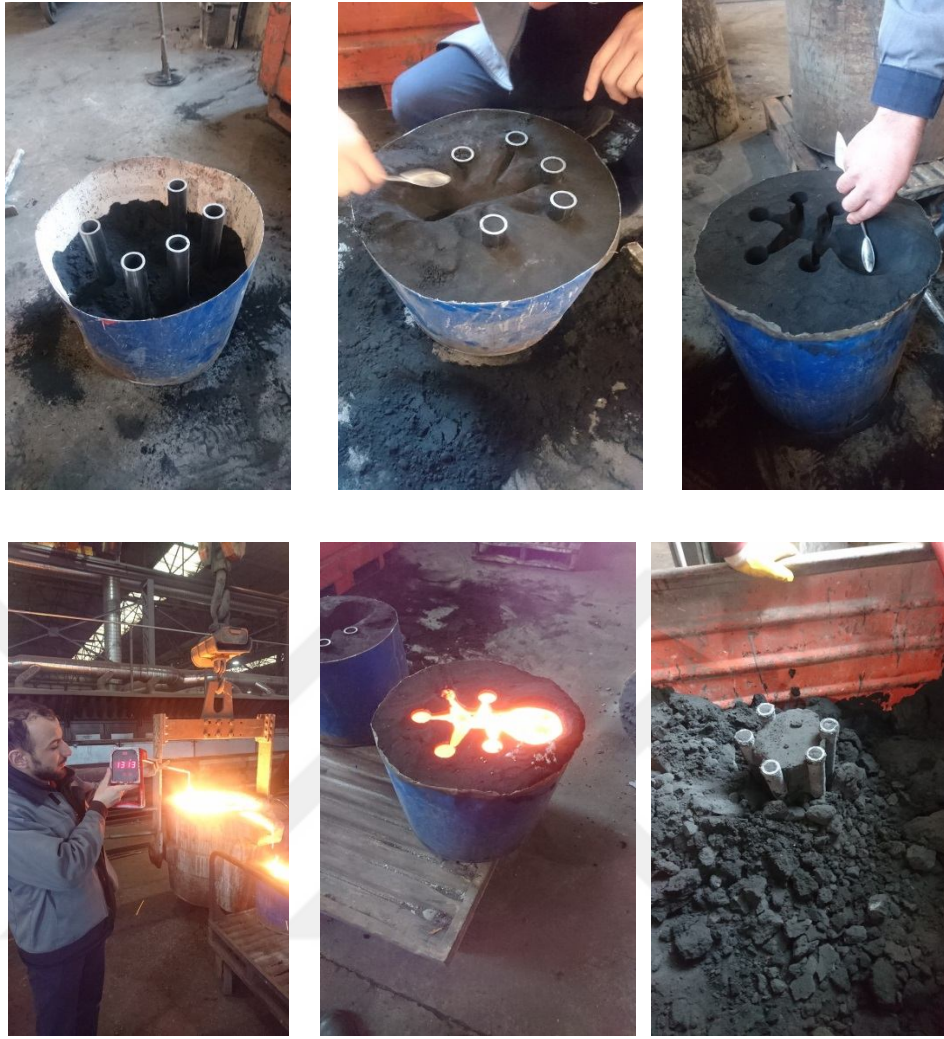
Şekil 4.12. Deney numunelerinin kalıbının hazırlanışı
