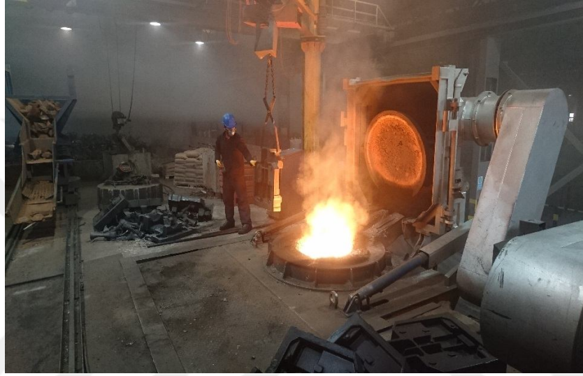
Şekil 4.9. Ergitme ocağına malzeme şarjı
