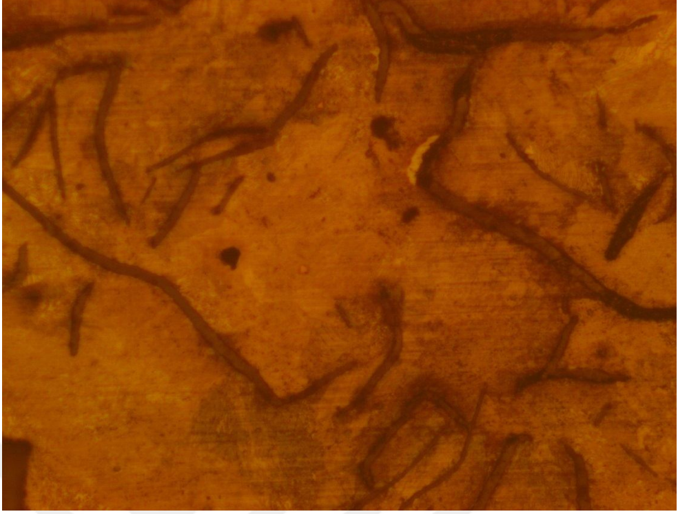
Şekil 5.5. 1 nolu Met-SiC numunesine ait dađlanmış 200X görüntüsü
