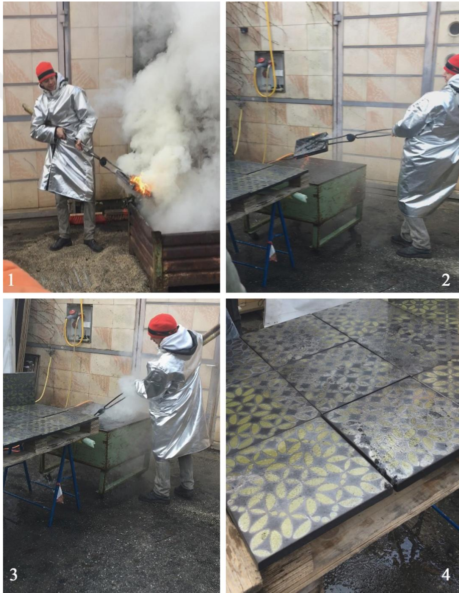
Şekil 4.5 Zemin ve duvar kaplamalarında kullanılan fayansın üretim aşaması (Kişisel arşiv, 2017)
