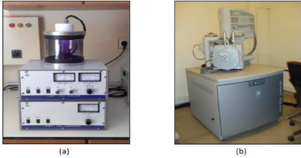
Şekil 3.13: (a) SEM cihazına ait Au kaplama ünitesi (b) SEM cihazı.
