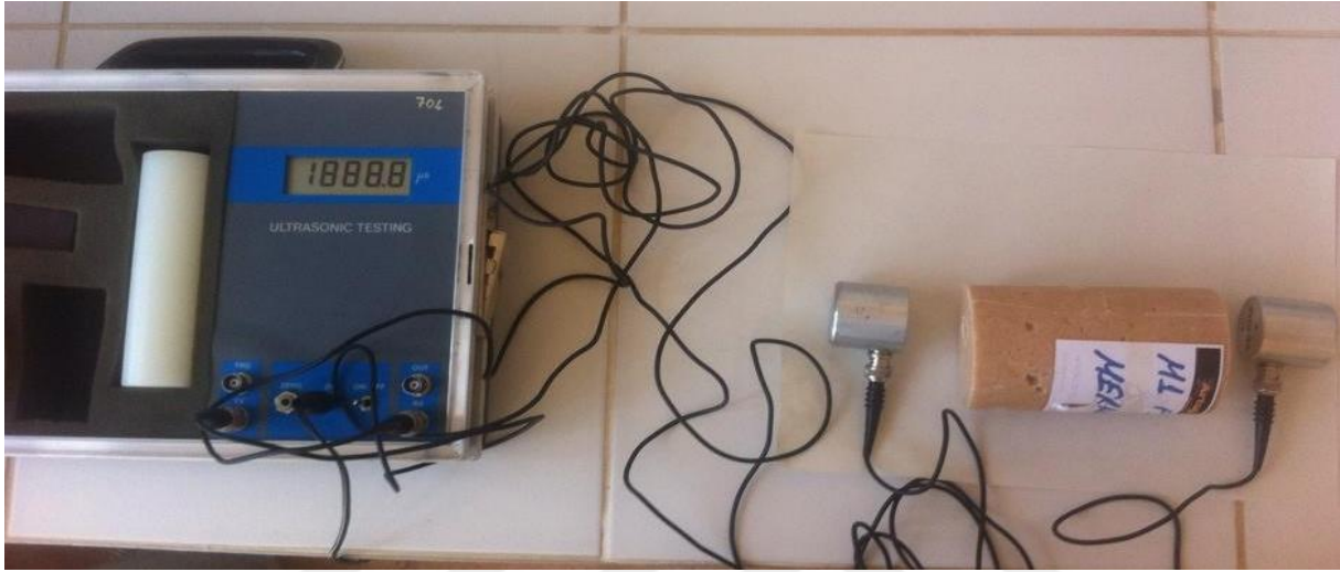
Şekil 3.10. Ultrasonik P-dalga hızını ölçen aletin görüntüsü
