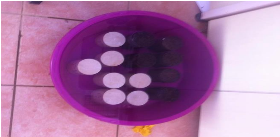
Şekil 3.6. Saf su içerisinde bekletilen örneklerin görüntüsü
