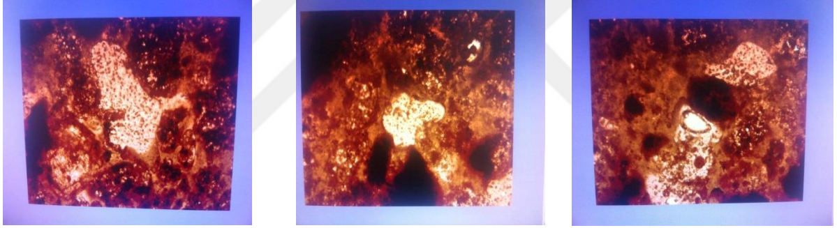
Şekil 4.11. Perlitden oluşturulan kompozit malzemenin mikroskop görüntüsü
