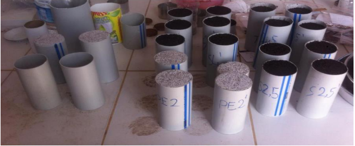
Şekil 3.4. Pomza ve perlit örneklerinin plastik boru içerisindeki görünüşü
