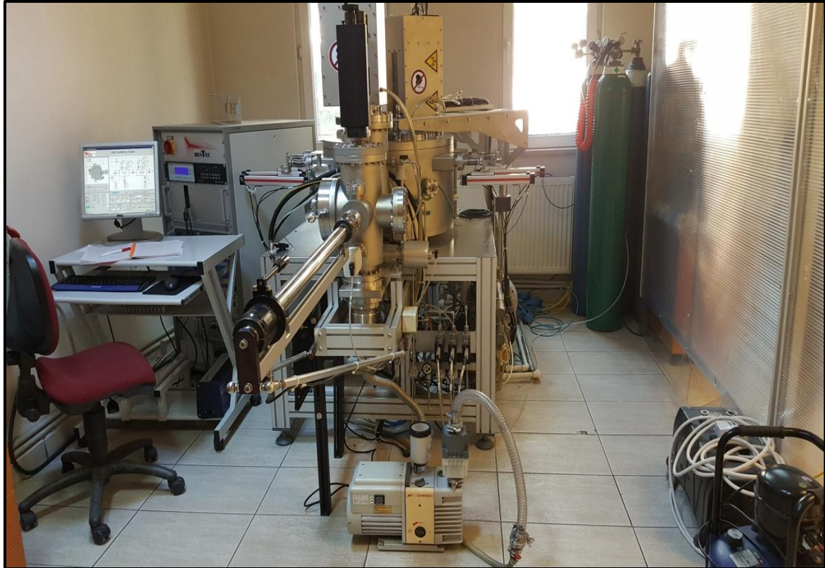
Resim 3.7. BESTEC Püskürtme sistemi (Magnetron Sputtering System)
