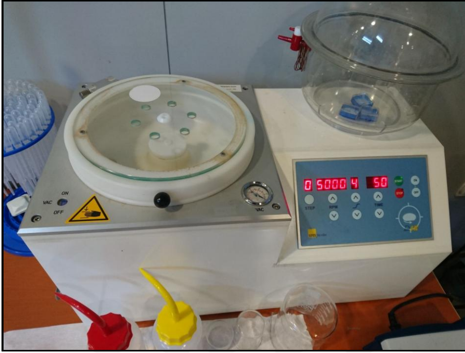
Resim 3.10. Dönel Kaplama Sistemi (Spin Coating System)
