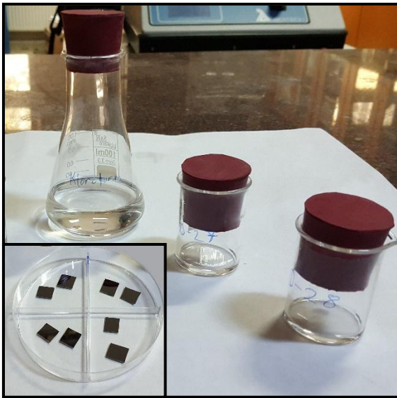
Resim 3.11. Çözelti hazırlanmasında kullanılan kloroform, N-Furan Naftalimit çözeltisi, N-Tiyofen Naftalimit çözeltisi ve kaplanacak Al/p-Si numuneler
