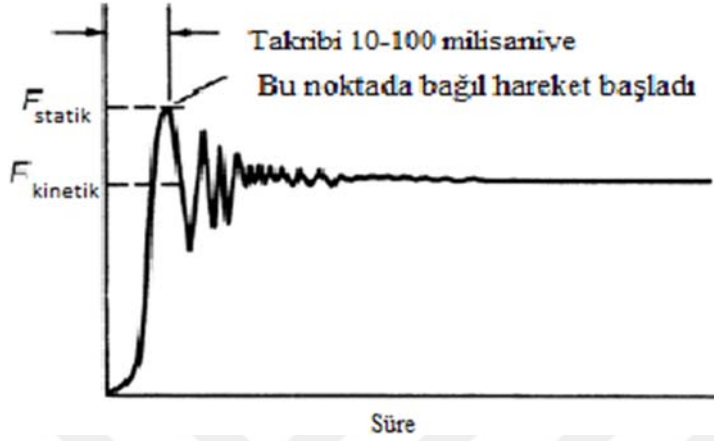
Şekil 4.5. Süreye bağlı olarak sürtünme kuvvetleri değişimi (Bhushan, 2013)
