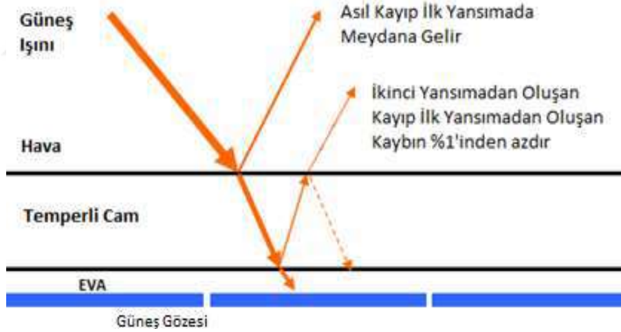
Şekil 2.8: Güneş Işınlarının FV modülünden Yansıması
