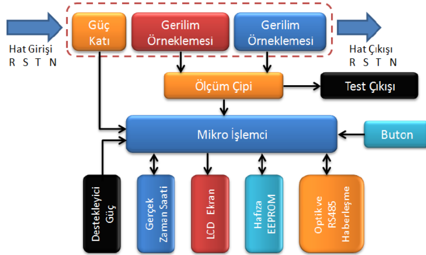
Şekil 3.2. Elektronik-elektrik sayaçların işlem katmanları
