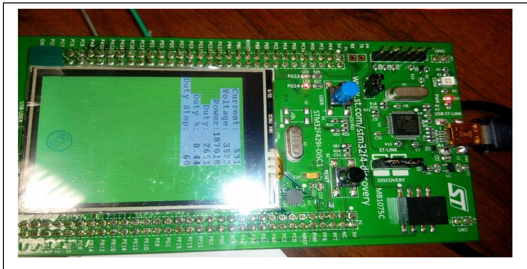
Şekil 3.9. STM32F429 mikrodenetleyici kartı
