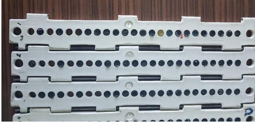
Şekil 82. Armür planına göre kartonun hazırlanması. (Ulaş, 2018)
