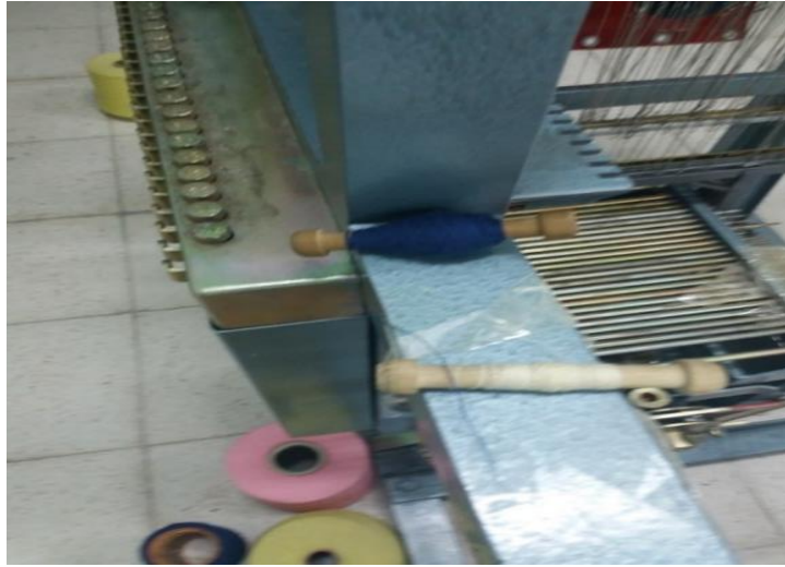
Şekil 87. Atkı ipliklerinin hazırlanması (Ulaş, 2018).
