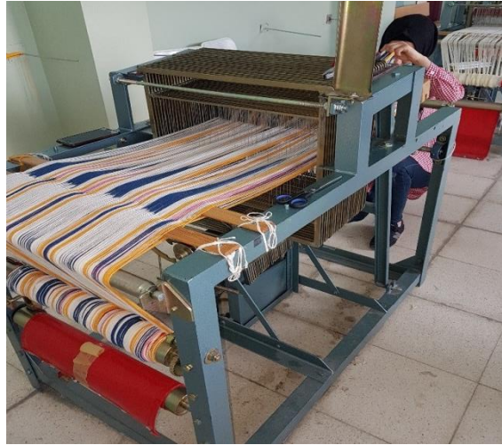
Şekil 86. Çözümlenmiş ipliklerin çözgü leventine bağlanması (Ulaş, 2018).
