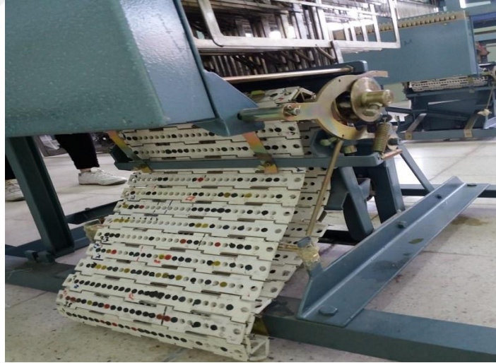
Şekil 84. Armür kartının tezgâha yerleştirilmesi (Ulaş, 2018)
