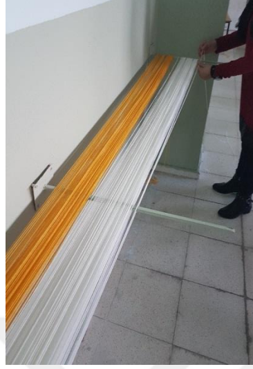
Şekil 76. Duvarda çözü hazırlama (Ulaş, 2018)
