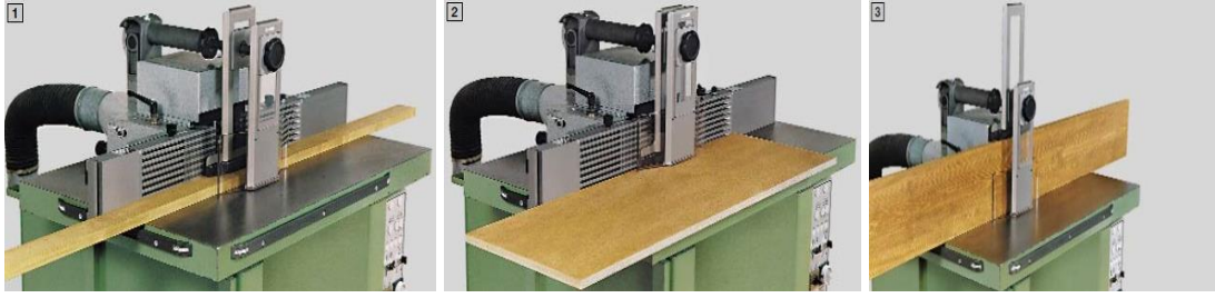
Şekil 4.7. Freze makinesinde siper, toz emme sistemi ve baskı donanımının kullanımı (AİGNER, 2015).
