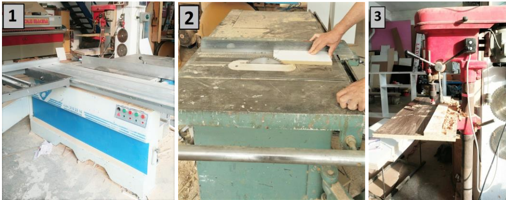
Şekil 4.17. Farklı makinelerde çalışma masası ve uygun uzatma donanımı
