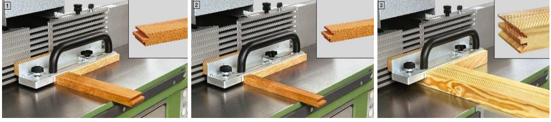
Şekil 4.9. Freze’de siper ve zıvana açmada kullanılan güvenli itme donanımı (AIGNER, 2015).
