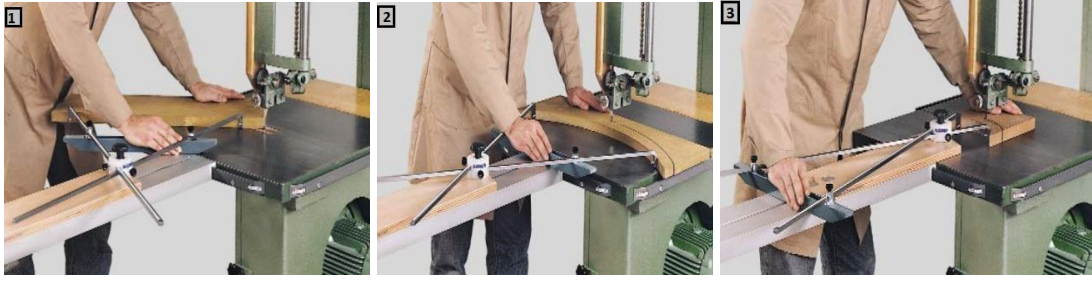
Şekil 4.16. Şerit Testere’de çalışma masası ve kavisli kesim için kalıp donanımı (AİGNER, 2015).
