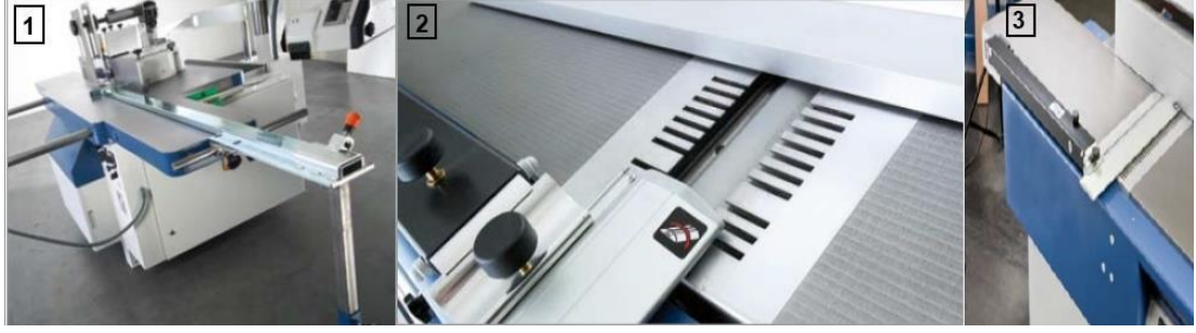
Şekil 4.5. Planya makinesinde ek tabla masası, ön-arka tabla ve bıçak örtücü donanım (Panhans, 2015).
