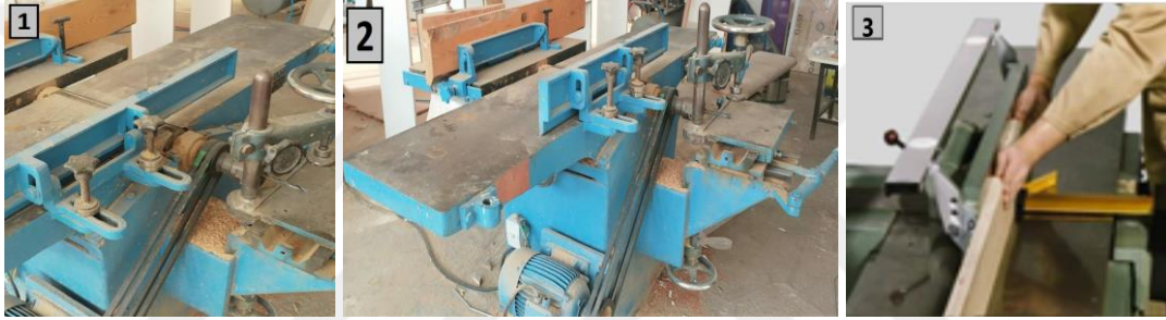
Şekil 4.4. Planya makinesinde bıçak örtücü donanım, siper, parça işleme kullanım.
