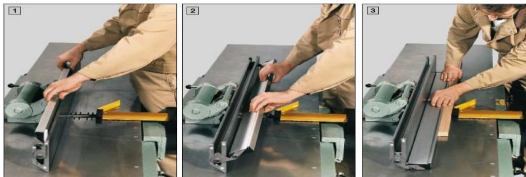
Şekil 4.3. Planya makinesinde siper ayarı ve iş parçası yüz-cumba işlenmesi (AIGNER, 2015).
