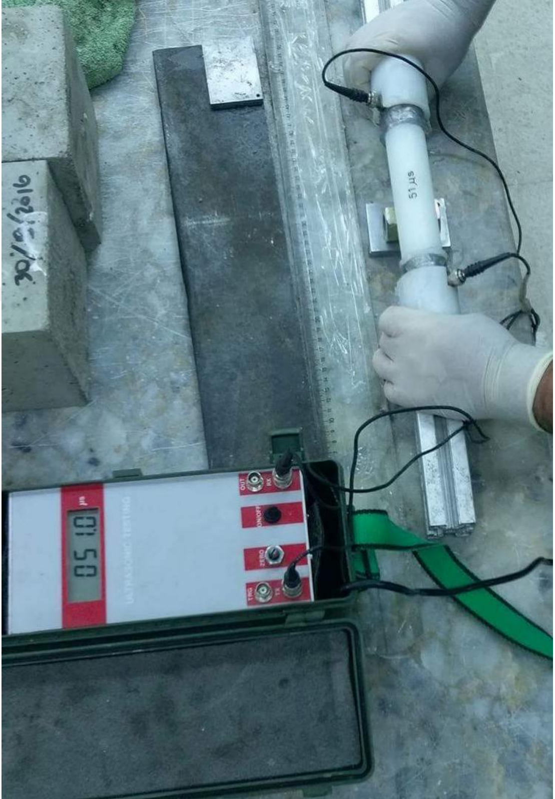
Şekil 3.10. Referans numune ile kalibrasyon.
