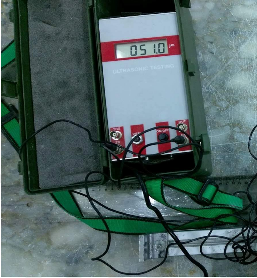
Şekil 3.9. Bu çalışmada kullanılan Ultrasonik test cihazı.
