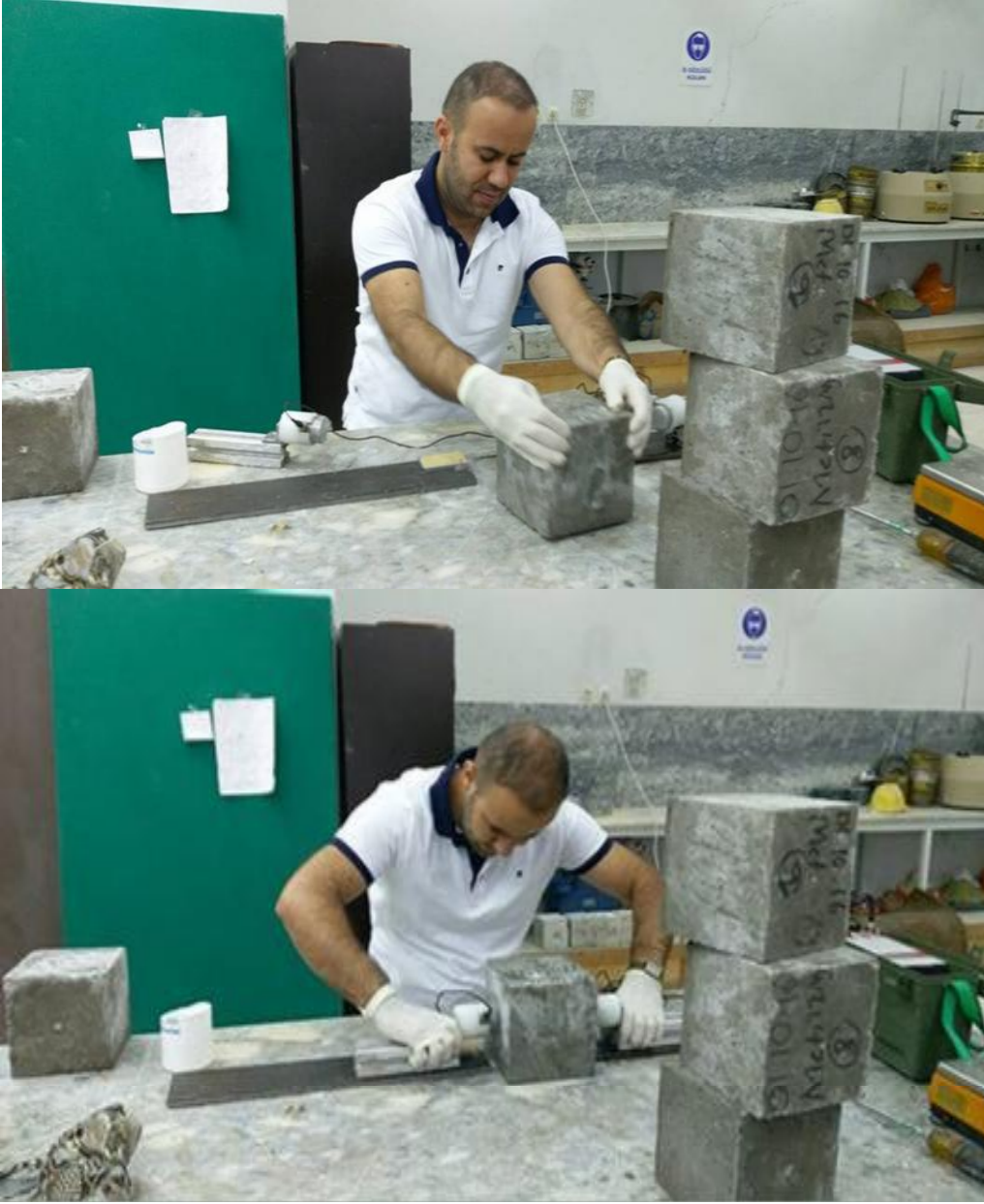
Şekil 3.11 UPV tetsti uygulanan bazı numuneler.
