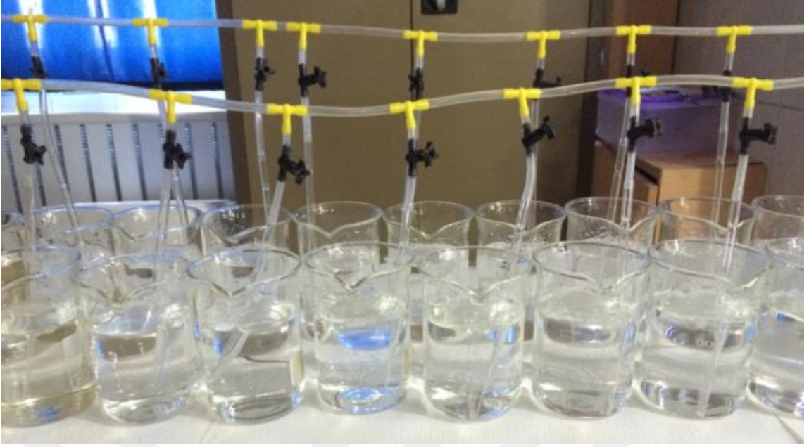
Şekil 3.3. D. magna biyodeneş düzeneđi (orijinal)
