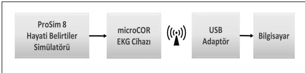
Şekil 3.11 Mİ erken tanı ve lokalizasyon tespit sisteminin blok diyagramı.
