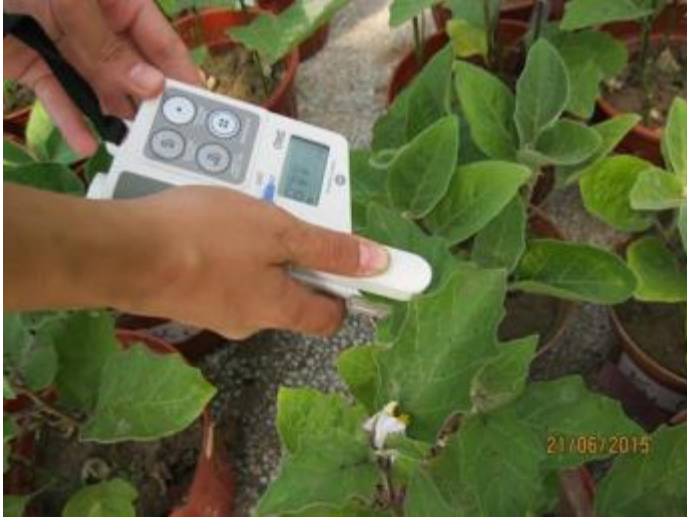
Resim 3.7. Klorofilmetre ile bitkilerin klorofil miktarı belirlenirken alınmış bir görüntü
