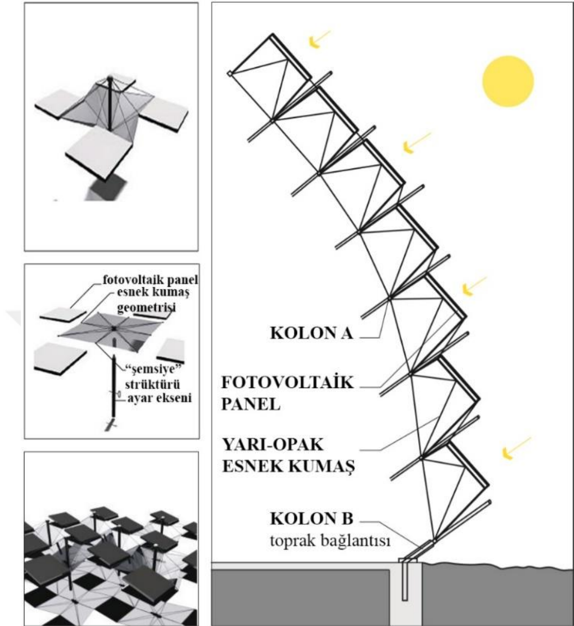
Şekil 2.17 Barınağa ait cephe sistem detayı (Mazzoleni, 2013)
