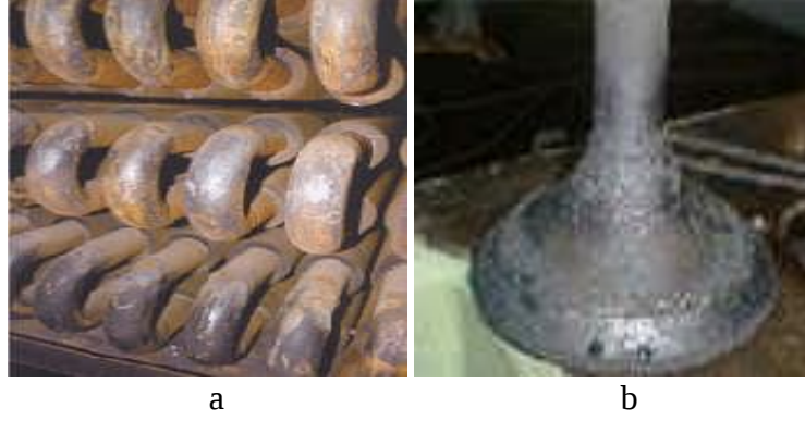
Resim 2.1 a) Isı deęiřtiricide atmosferik kořullarda yuėsek sıcaklık korozyonu, b) Vanadyum ile yuėsek sıcaklık korozyonuna uęramıř egzoz valfi. (MEB 2007).
