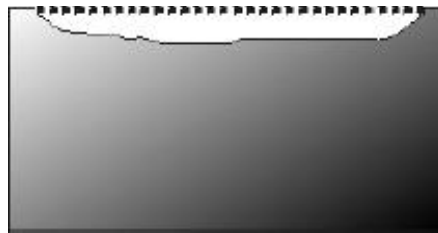
Şekil 2.20 Homojen dağılımlı korozyon (Görener 2007).
