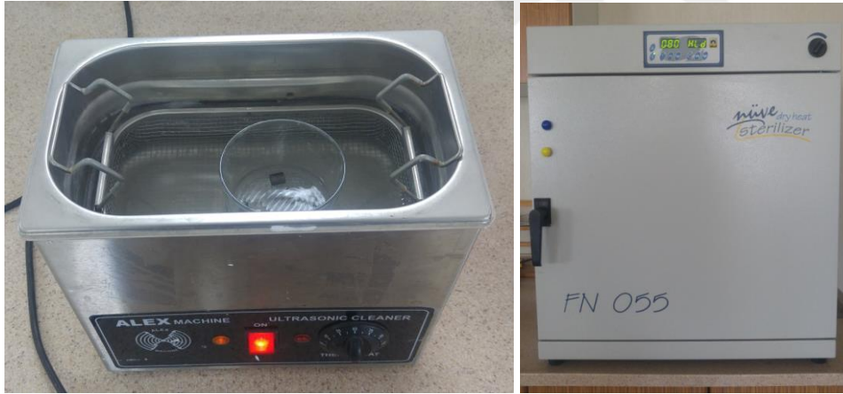
Resim 3.5 a) Ultrasonik banyo, b) ETÜV fırını.
