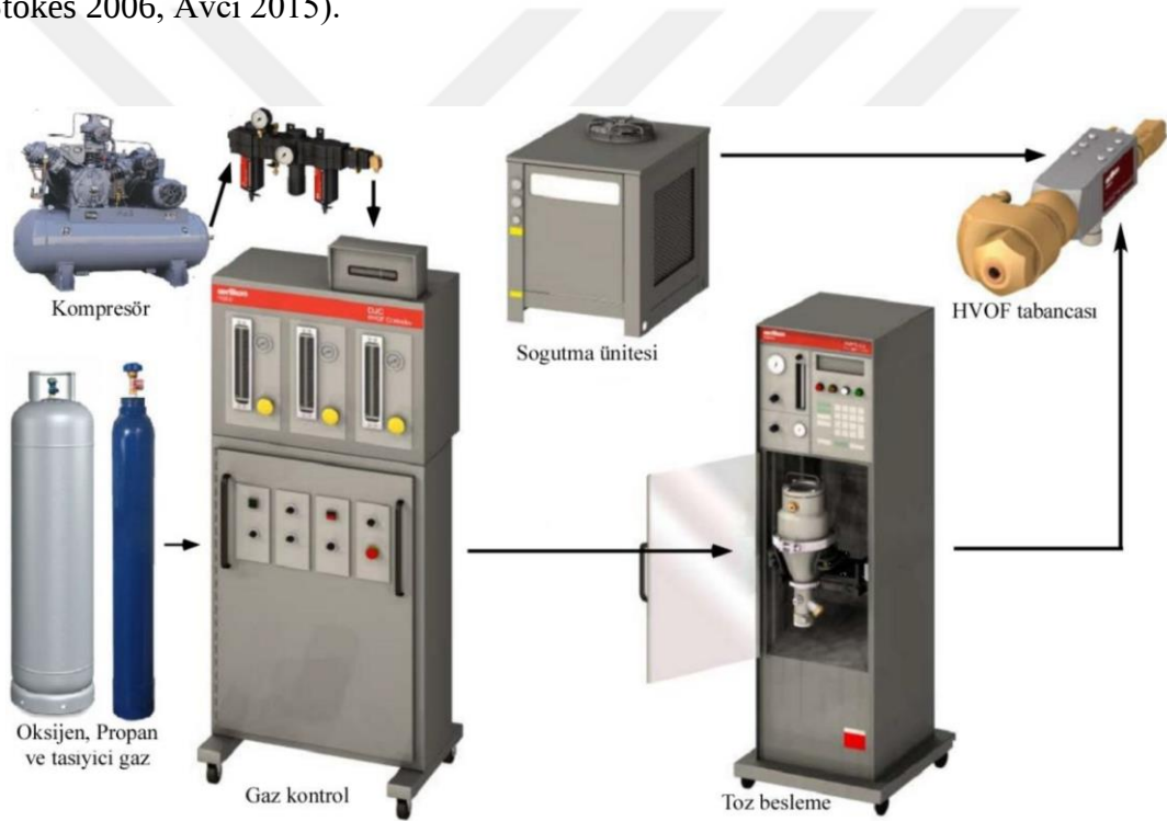
Şekil 2.13 HVOF yöntemi kaplama sistemi (Gök 2015).
