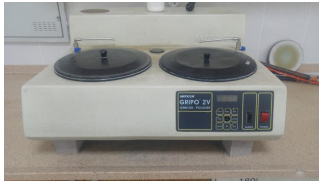
Resim 3.9 Metkon marka zımpara ve parlatma cihazı.
