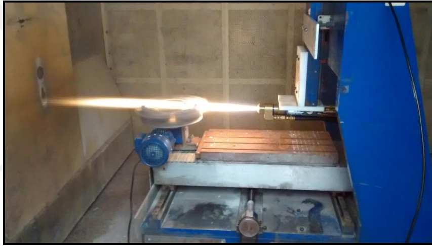
Resim 3.3 HVOF yöntemi kaplama sistemi.
