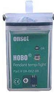
Şekil 3.10. Denemelerde kullanılan su geçirmez Hobo marka sıcaklık datalogeri
