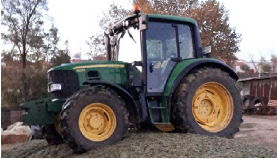
Şekil 3.2. Denemelerde kullanılan sıkıştırma aracı ve ekipmanı
