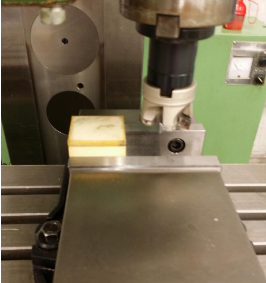
Resim 3.7. Köpük blok üzerine talaş kaldırma işlemin uygulanması
