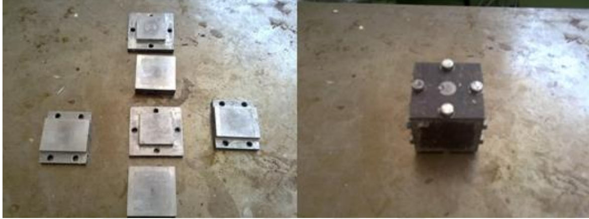
Resim 3.4. Köpük kalıbının birleştirilmemiş ve monte edilmiş hali
