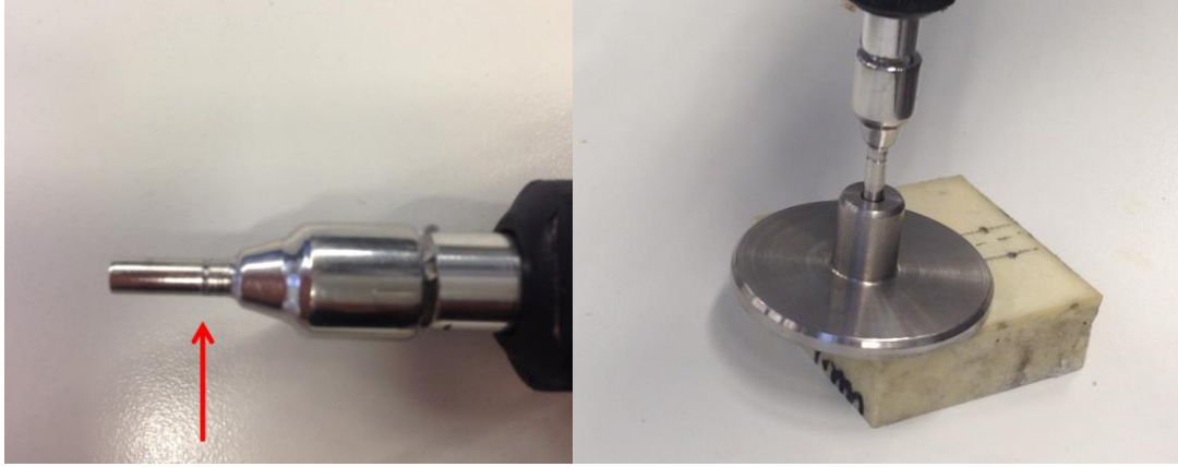
Resim 3.15. Çakma işlemlerinde mini-implantların aynı derinliğinde yerleştirilebilmesi için tork metre ucuna yapılan rehber çizgi
