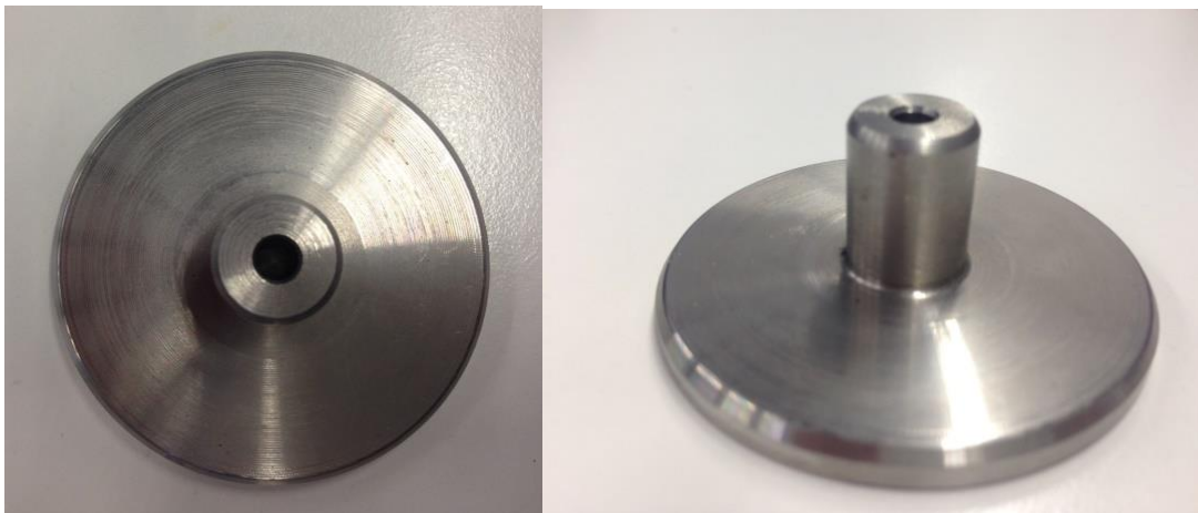
Resim 3.14. Çakma işlemlerinde mini-implantların dik açı ile yerleştirilebilmesi için ve yerleştirme esnasında mini-implant sallanmaması için kullanılan rehber parçası
