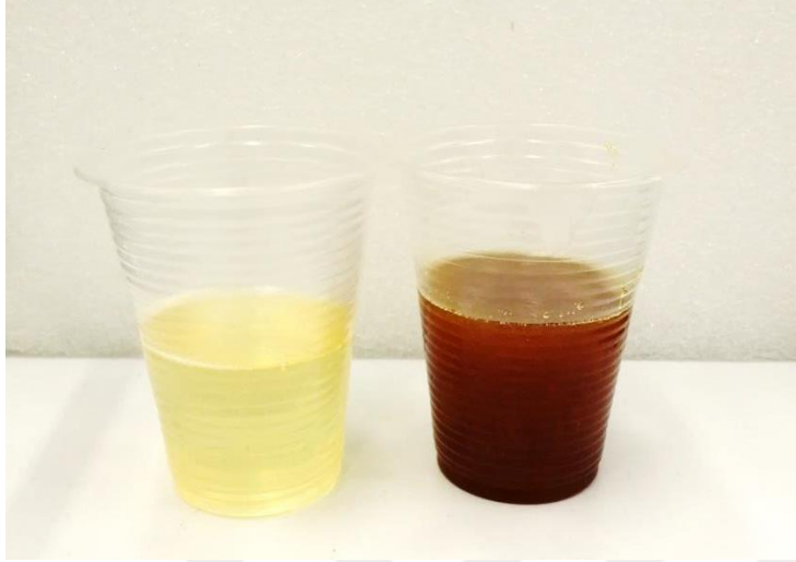
Resim 3.2. Poliüretan blokların hammaddesi: poliöl (solda) ve polizosiyanat (sağda)
