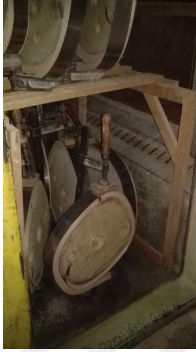
Şekil 4. Bükülmüş ağaç malzeme şeklin sabitlenmesi sac kalıba sabitlenmiş durumda kurutulması (Özdemir,N., 2018, Firma 5)
