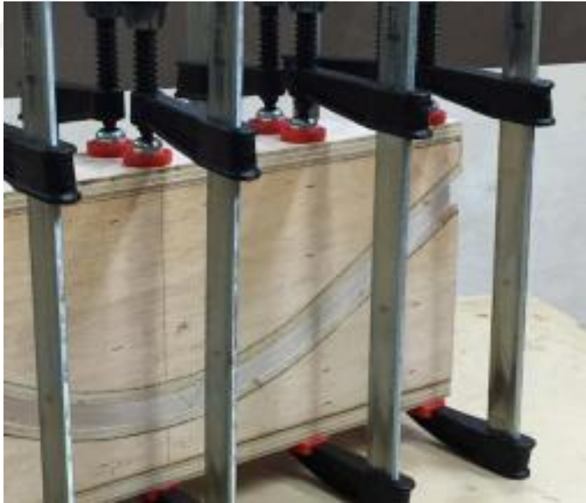
Şekil 6. Kalıba işkenceler ile sabitlenmiş tutkallanmış ahşap katmanları [18]
