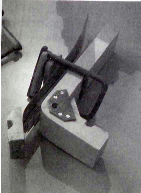
Şekil 21. Stool 60'ın lamine ahşap ayaklarının bükme işlemi sırasında kalıptaki hali [27]
