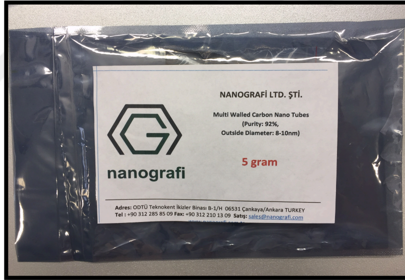
Resim 6. Deneyde kullanılan çoklu duvarlı karbon nanotüp (Nanografi).
