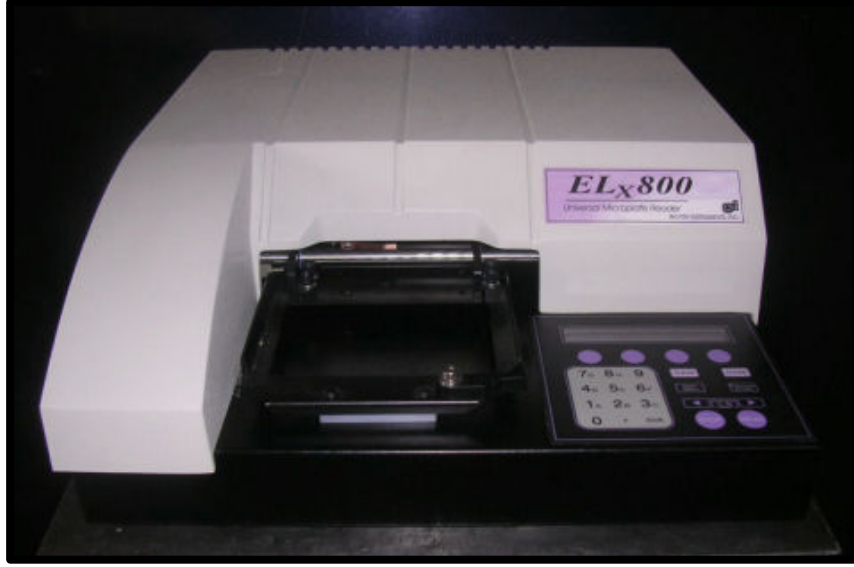
Resim 27. Optik yoğunluk (OD) ölçümlerinin yapıldığı spektrofotometre cihazı.
