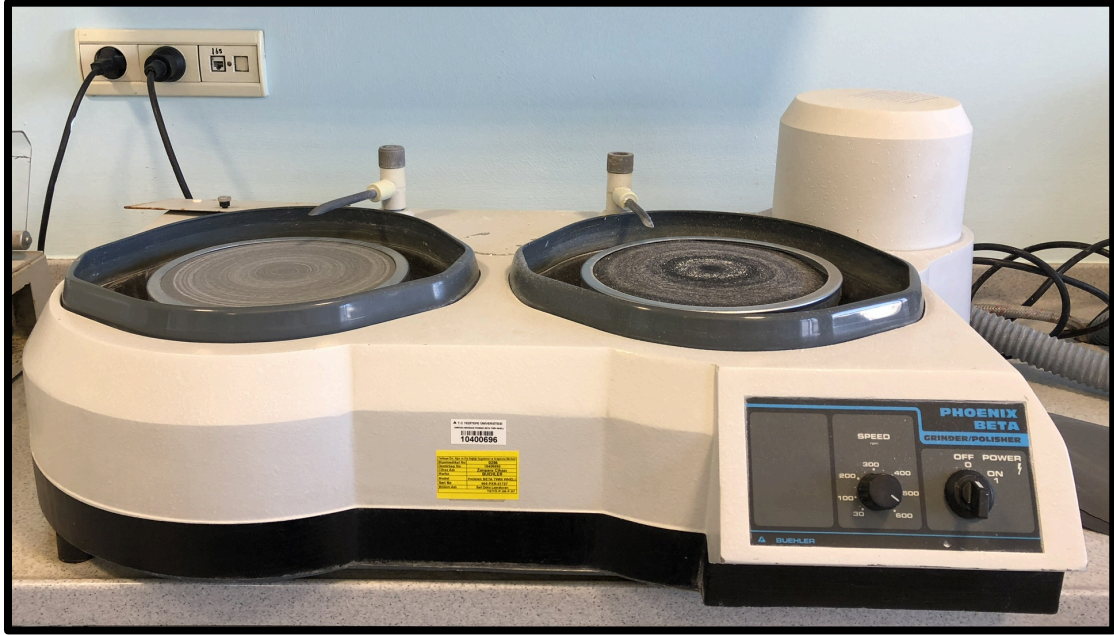
Resim 20. Deneyde kullanılan su zımparası cihazı (Phoenix Beta Grinder Polisher, Buehler).
