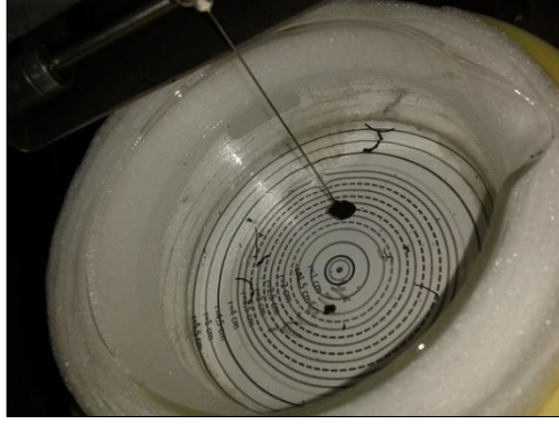
Şekil 5.13: Ultrases uygulanmış GO dispersiyonundan iplik eldesi sırasında meydana gelen görüntü.
