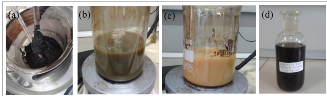
Şekil 4.1: Hummers yöntemi ile grafitin oksidasyonun farklı aşamalardaki görüntüsü.
