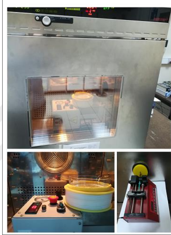
Şekil 4.6: Memmert CTC 256 İklimlendirme kabini ve içerisine adapte edilen yaş çekim sistemi.
