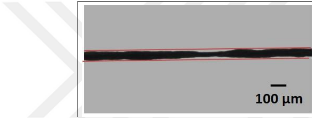
Şekil 5.12: 27G enjektör ucu ile elde edilen GO ipliğe ait bir mikroskop görüntüsü.
