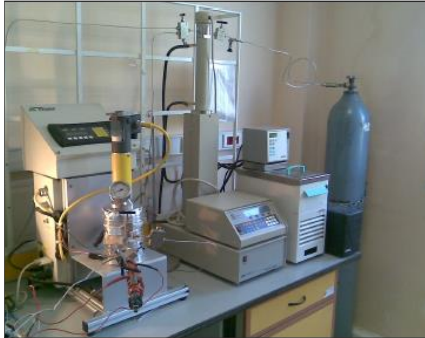
Şekil 4.3: GO partiküllerinin tabakalarına ayrılması (eksfoliasyon) işlemi için kullanılan basınçlı CO 2 sistemi.
