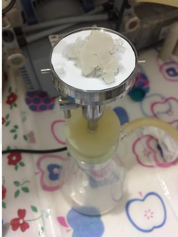
Şekil 4.6. Strüvit kristallerinin AKM setinde süzölmesi
