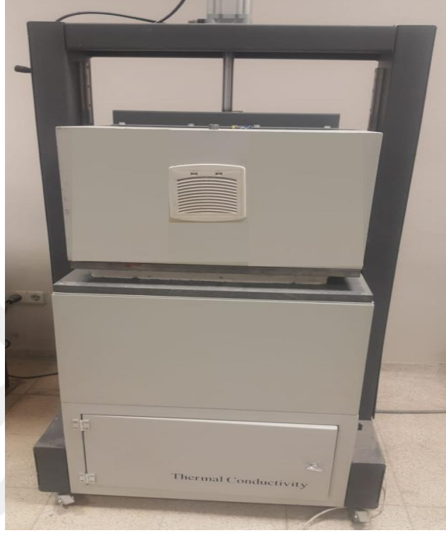
Şekil 4.19. Sıcak plaka ısı iletkenlik cihazının görüntüsü
