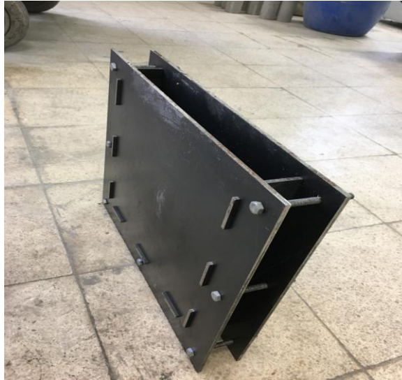
Şekil 3.3. Plaka dökümlerinin yapıldığı kalıp
