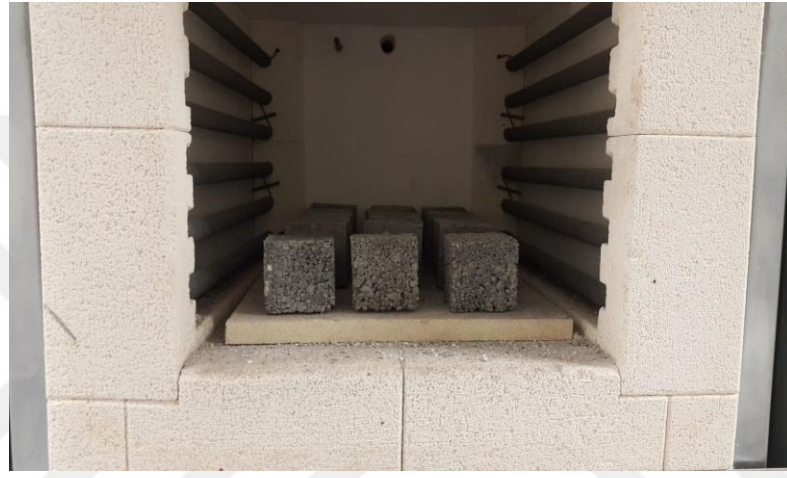
Şekil 4.9. Numunelerin fırına yerleştirilmesi
