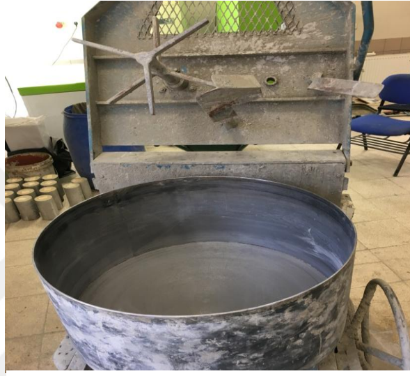
Şekil 3.2. Harçların karıştırıldığı mikser
