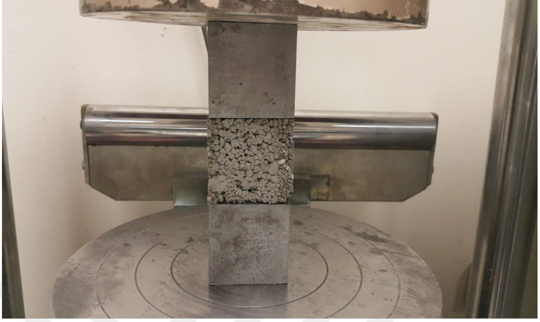
Şekil 4.14. Küp numunelerin basınç yüklerinin belirlenmesi için cihaza yerleştirilmesi
