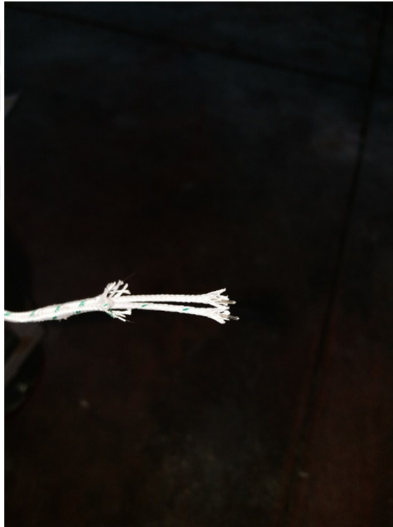
Figure 3.4. 0,8 mm Type K wire thermocouple wire.
