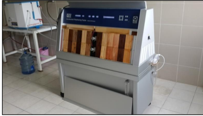
Şekil 2.9. Hızlandırılmış test cihazındaki örneklerin yerleşimi [Foto Gürleyen].
