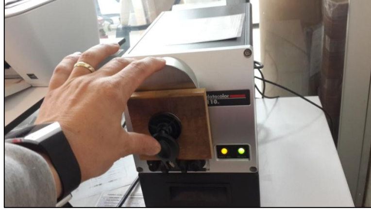
Şekil 2.14. Datacolor 110 TM spectrophotometer cihazı (ASD Orman Ürünleri A.Ş. Fabrikası ARGE Laboratuvarı) [Foto Gürleyen].
