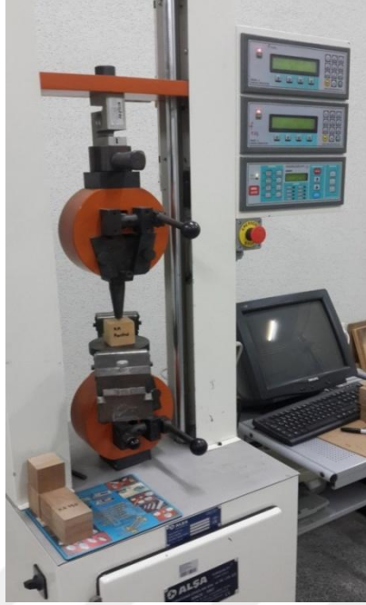
Şekil 2.28. Janka sertlik deneyi [Foto Gürleyen].
