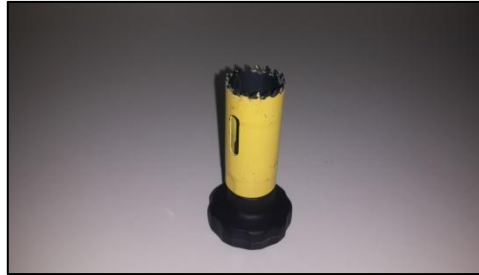
Şekil 2.26. Çekme silindirinin çevresindeki yapıştırıcı taşmalarının alınmasında kullanılan kesici alet [Foto Gürleyen].
