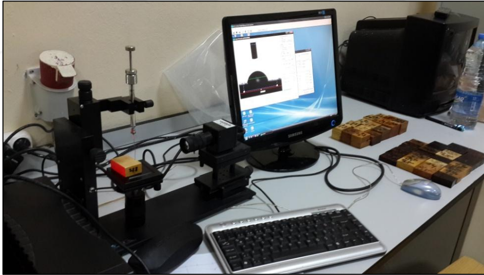
Şekil 2.20. Islanabilirlik test cihazında örneklerin ölçümü (İstanbul Üniversitesi) [Foto Gürleyen].
