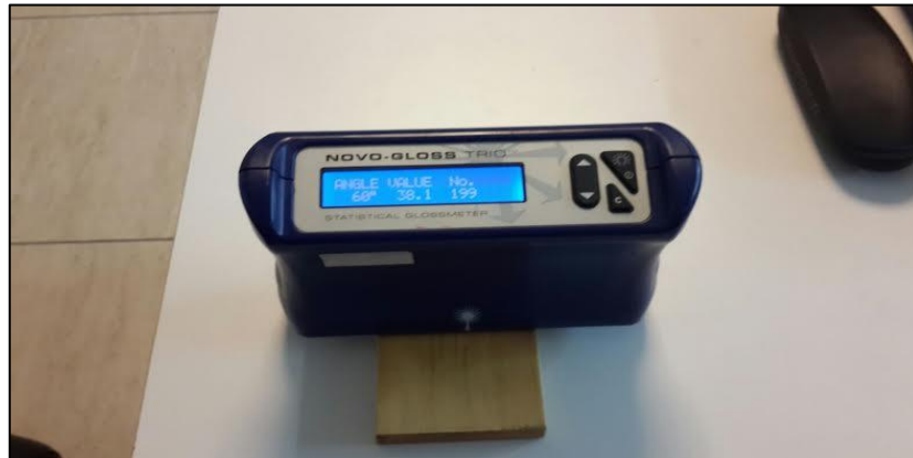
Şekil 2.16. Boya / vernik katmanı yüzey parlaklık ölçüm cihazı [Foto Gürleyen].
