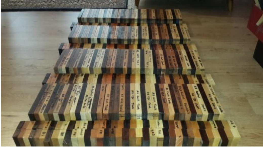
Şekil 2.7. Hızlandırılmış UV yaşlandırma uygulaması için hazırlanan deney örnekleri [Foto Gürleyen].
