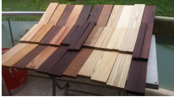
Şekil 2.6. Su-bazlı tek bileşenli verniğin uygulaması [Foto Gürleyen].
