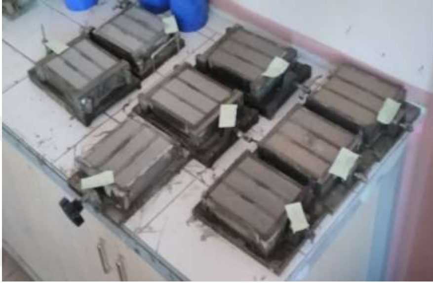
Fotoğraf 3.9. Bulamaçların kalıplara yerleştirilmiş hali
