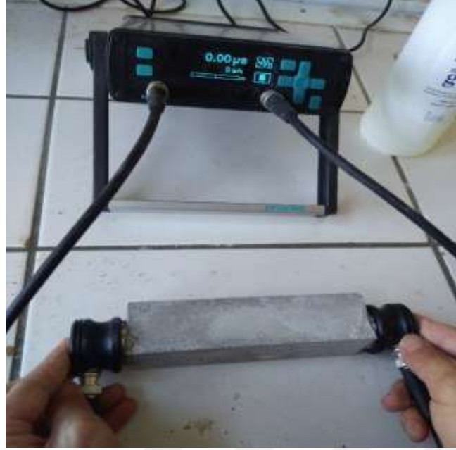
Fotoğraf 3.11. 40x40x160 mm numunelerin UGH belirlenmesi
