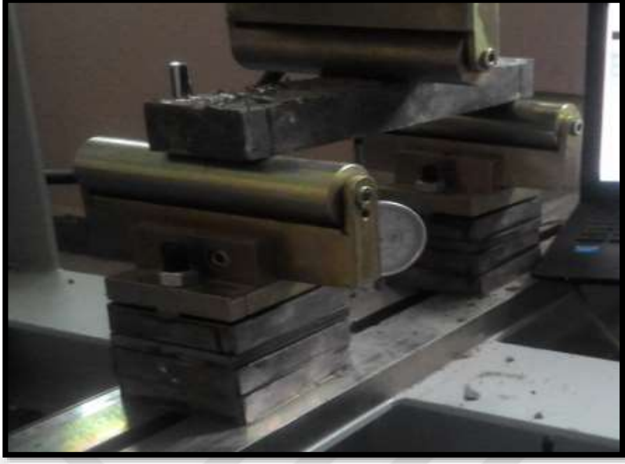
Fotoğraf 3.16. SIFCON eğilme dayanımı deney düzeneği
