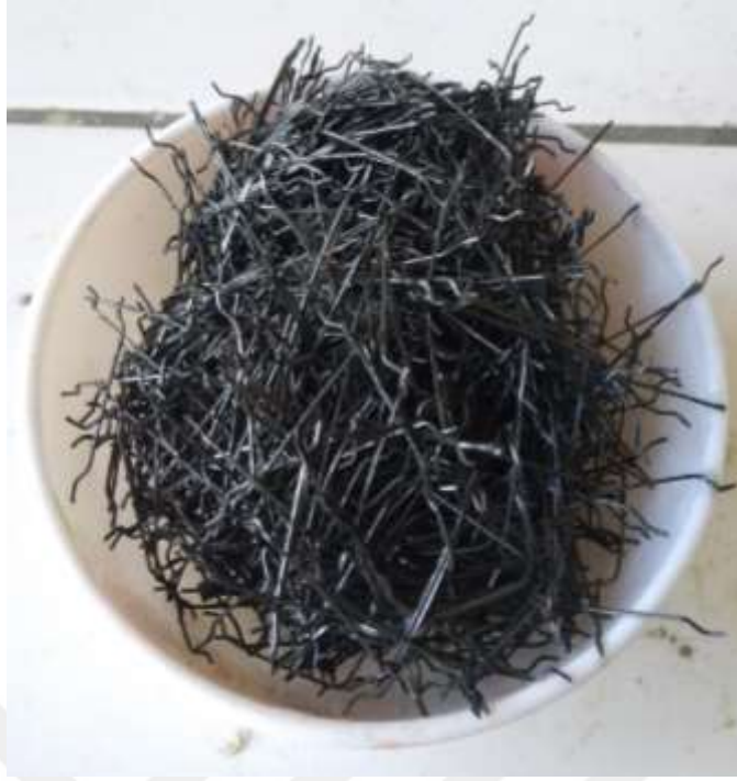
Fotoğraf 3.4. Kullanılan çelik lifler
