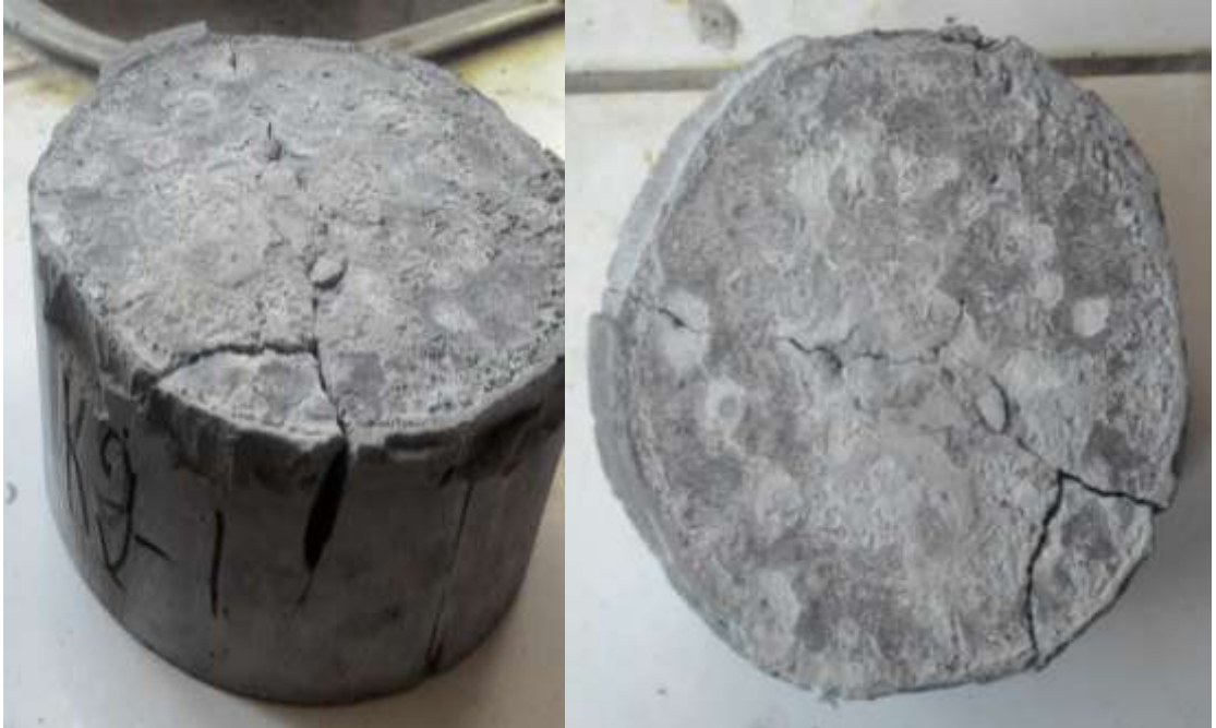
Fotoğraf 4.2. Çatlak oluşan silindirik numune
