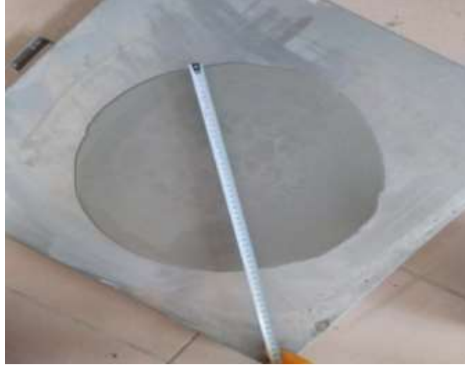
Fotoğraf 3.7. SIFCON bulamacı yayılma çapı deneyi
