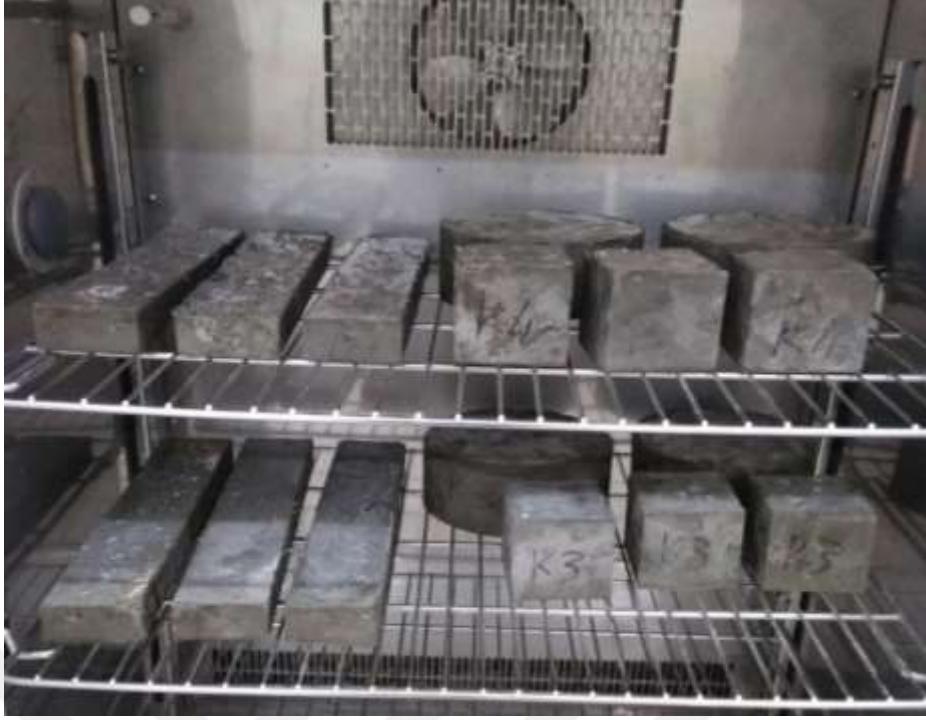
Fotoğraf 2.4. SIFCON numunelerine kuru kr uygulaması
