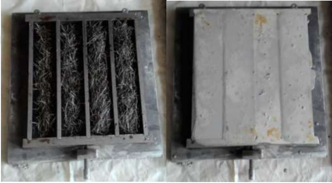
Fotoğraf 3.10. SIFCON kiriş numuneleri
