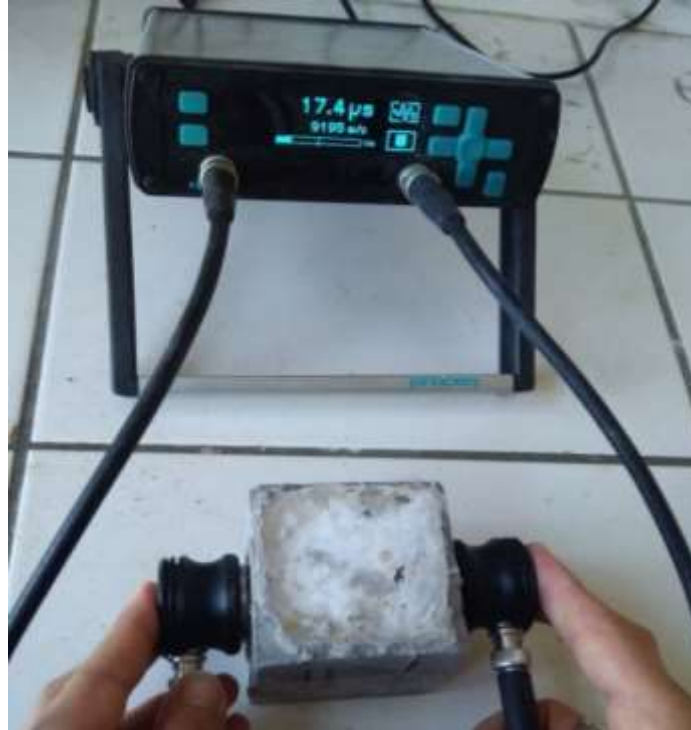
Fotoğraf 3.14. 71x71x71 mm numunenin UGH belirlenmesi
