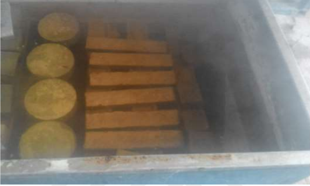
Fotoğraf 2.3. SIFCON numunelerine hızlı kür uygulaması
