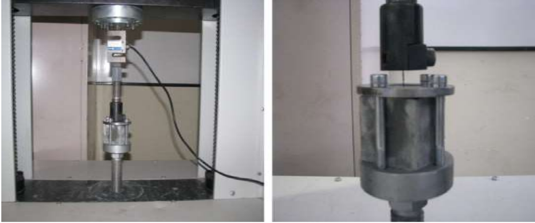
Fotoğraf 2.5. SIFCON’da çelik lif aderansının Pull-Out deneyi ile belirlenmesi
