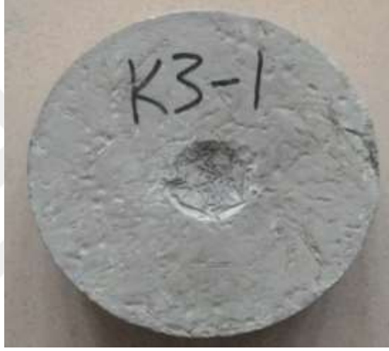
Fotoğraf 4.1. SIFCON darbe deneyi uygulanan silindir numune
