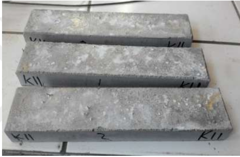
Fotoęraf 3.15. 30x60x300 mm boyutlarındaki kiriř numuneleri
