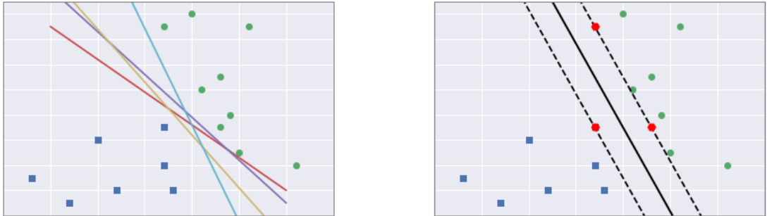
Şekil 1.2. (a) İki sınıflı problem için hiper düzlemler, (b) Optimum hiper düzlem ve destek vektörleri
