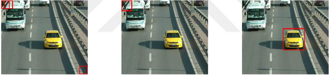
Şekil 2.3. Kayan pencere tekniği uygulanarak araç algılama
