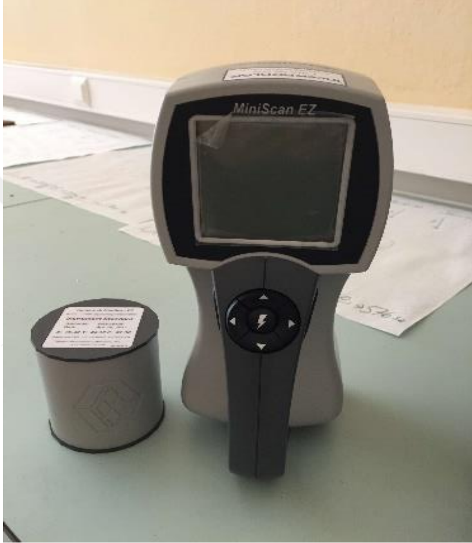
Şekil 3.5: Hunterlab MiniScan EZ Renk Ölçüm Cihazı.
