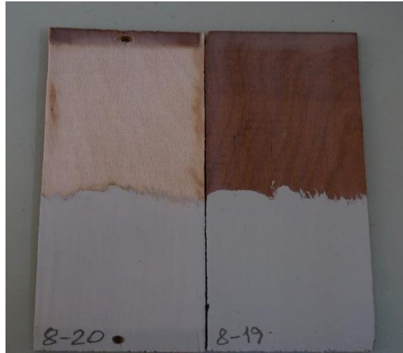
Şekil 4.20: 190°C ısıtıl işlem uygulanmış akçaağaç örneklerinin nano TiO 2 ekli numunesinin 864 saat yaşlandırma sonrası ve öncesi renk farklılığı.
