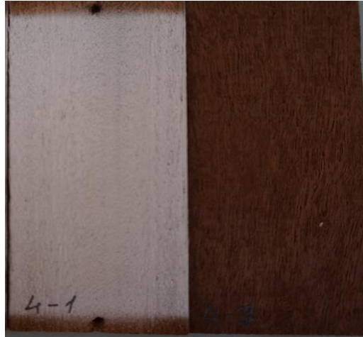
Şekil 4.1: Isıl işlem uygulanmamış sapelli kontrol numunesinin 864 saat yaşlandırma sonrası ve öncesi görünümü.
