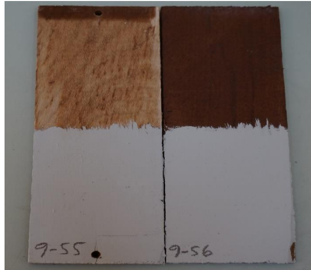
Şekil 4.24: 212°C ısıtma işlemi uygulanmış akçağaç örneklerinin nano kil+nano ZnO ekli numunesinin 864 saat yaşlandırma sonrası ve öncesi renk farklılığı.
