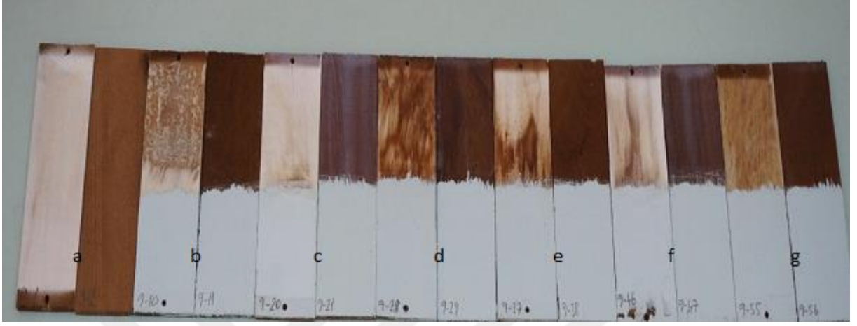
Şekil 4.26: 212°C ısıtılmış işlem uygulanmış akçaağaç örneklerinin sırasıyla kontrol (a), sadece vernik-boya (b), nano TiO 2 (c), nano ZnO (d), nano kil (e), nano kil+nano TiO 2 (f), nano kil+nano ZnO' lu (g) varyasyonlarının 864 saat yaşlandırma sonrası ve öncesi renk farklılığı.
