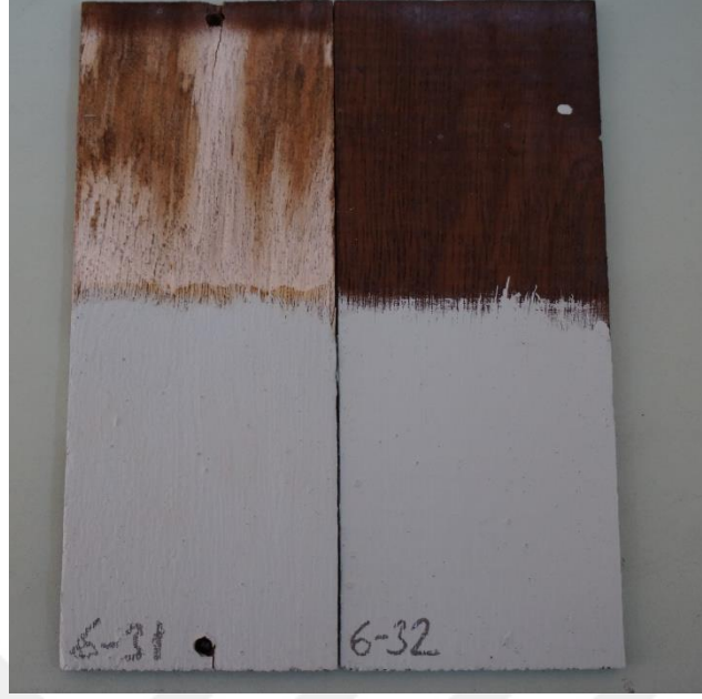
Şekil 4.12: 212°C ısıtıl işlem uygulanmış sapelli örneklerinin nano kil+nano ZnO ekli numunesinin 864 saat yaşlandırma sonrası ve öncesi renk farklılığı.
