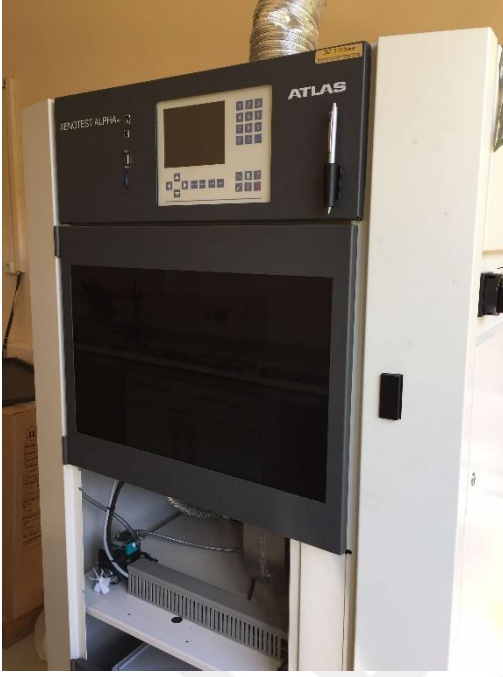
Şekil 3.6: Atlas Xenotest Alpha+ Yapay Yaşlandırma Cihazı Ve Cihaza Ait Xenon-Ark Lambası.
