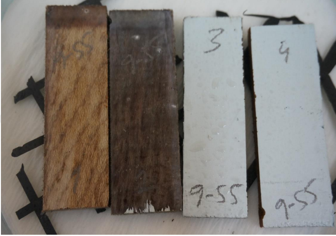
Şekil 4.54: 864 saat yaşlandırılmış ve 212°C ısıtılmış ve 212°C ısıtılmış akçağaç örneğinin 1. Hafta sonundaki küflenme durumu.
