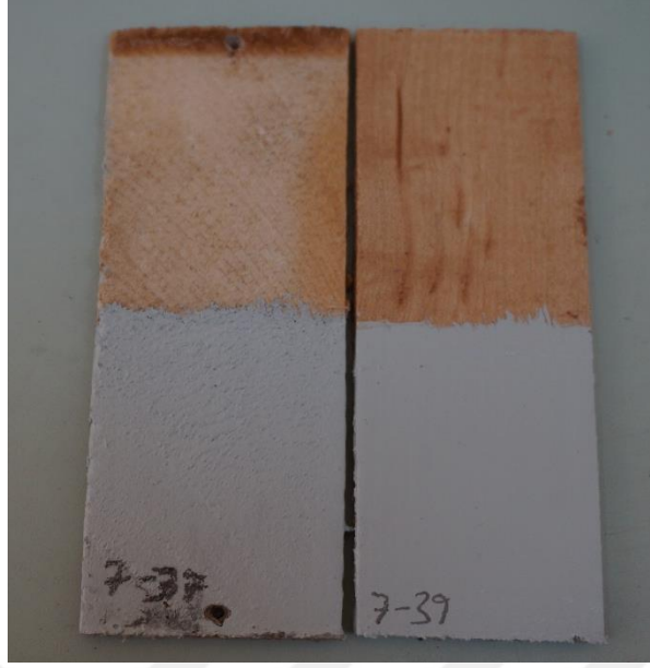
Şekil 4.16: Isıl işlem uygulanmamış akçaağaç örneklerinin nano kil ekli numunesinin 864 saat yaşlandırma sonrası ve öncesi renk farklılığı.
