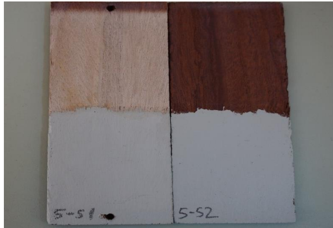
Şekil 4.8: 190°C ısıt işlem uygulanmış sapelli örneklerinin, nano kil+nano TiO 2 ekli numunesinin 864 saat yaşlandırma sonrası ve öncesi renk farklılığı.
