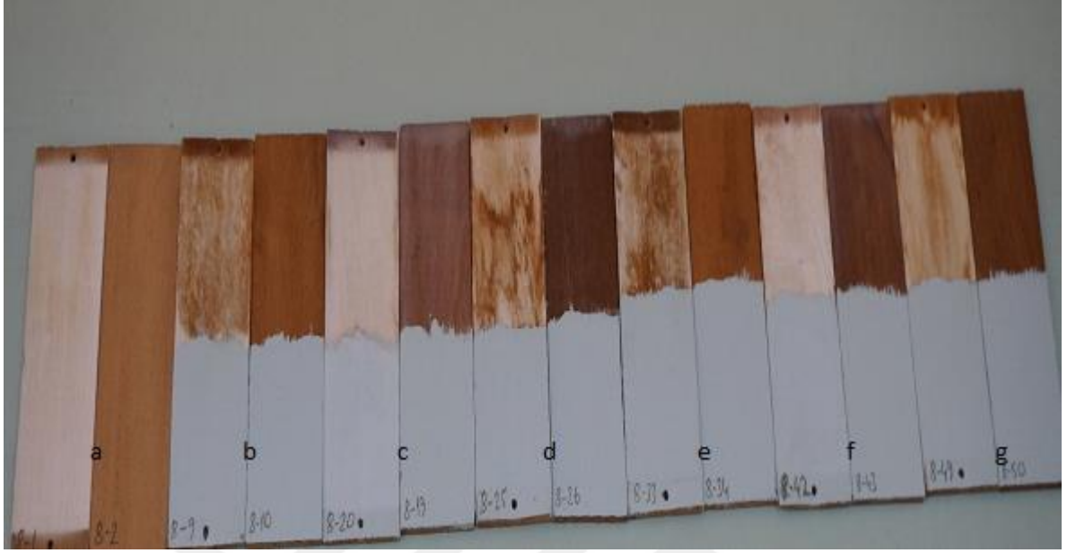
Şekil 4.22: 190°C ısıtıl işlem uygulanmış akçaağaç örneklerinin sırasıyla kontrol (a), sadece vernik-boya (b), nano TiO 2 (c), nano ZnO (d), nano kil (e), nano kil+nano TiO 2 (f), nano kil+nano ZnO' lu (g) varyasyonlarının 864 saat yaşlandırma sonrası ve öncesi renk farklılığı.
