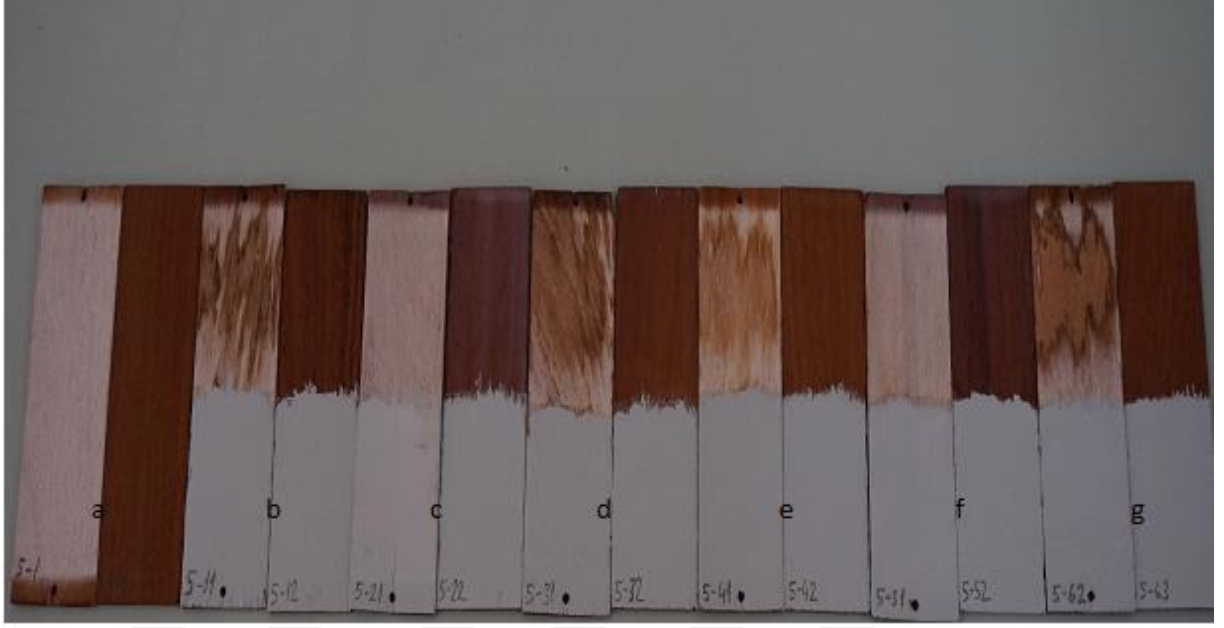
Şekil 4.10: 190°C ısıt işlem uygulanmış sapelli örneklerinin sırasıyla kontrol(a),sadece vernik-boya (b), nano TiO 2 (c), nano ZnO (d), nano kil (e), nano kil+nano TiO 2 (f), nano kil+nano ZnO' lu (g) varyasyonlarının 864 saat yaşlandırma sonrası ve öncesi renk farklılığı.
