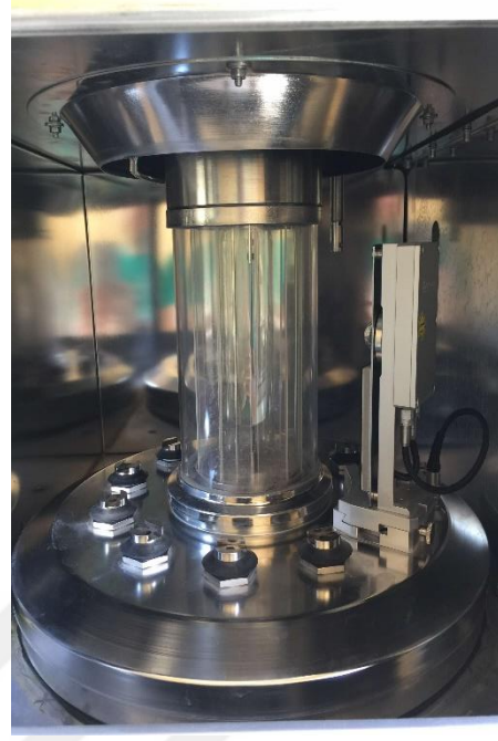
Şekil 3.6: Atlas Xenotest Alpha+ Yapay Yaşlandırma Cihazı Ve Cihaza Ait Xenon-Ark Lambası.
