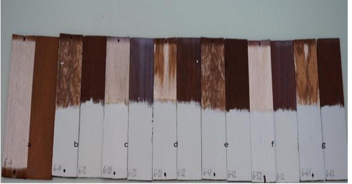
Şekil 4.14: 212°C ısıtma işlemi uygulanmış sapelli örneklerinin sırasıyla kontrol (a), sadece vernik-boya (b), nano TiO 2 (c), nano ZnO (d), nano kil (e), nano kil+nano TiO 2 (f), nano kil+nano ZnO' lu (g) varyasyonlarının 864 saat yaşlandırma sonrası ve öncesi renk farklılığı.
