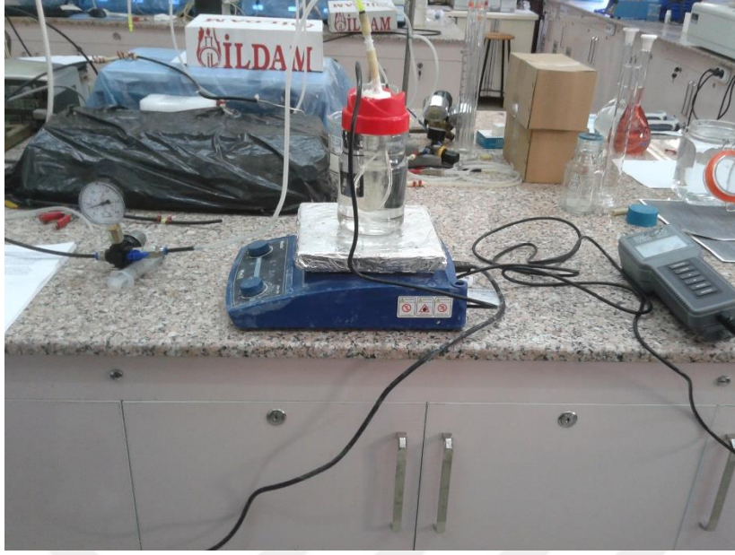
Şekil 3.13. Oksijen difüzyon hızlarının belirlenmesi için kurulan test düzeneği
