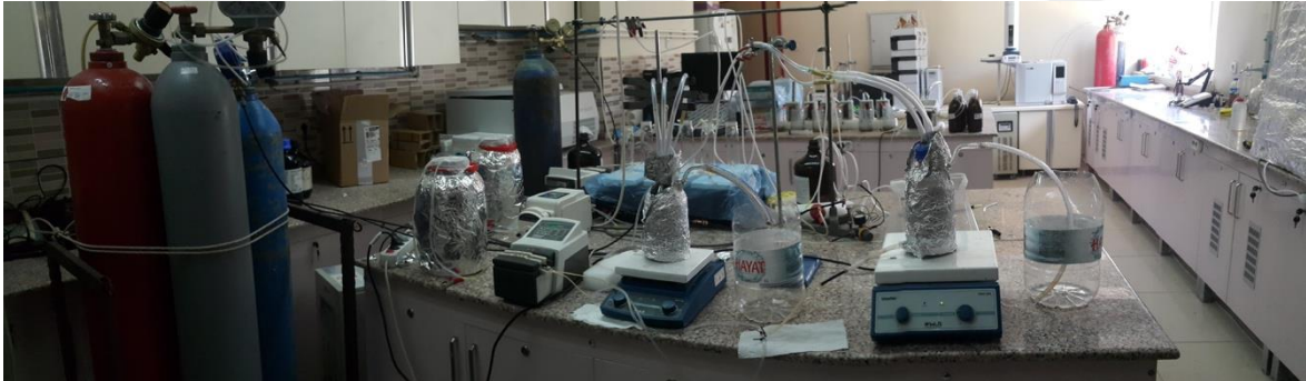
Şekil 3.15. Laboratuvar ölçekli membran biyofilm reaktör sistemi
