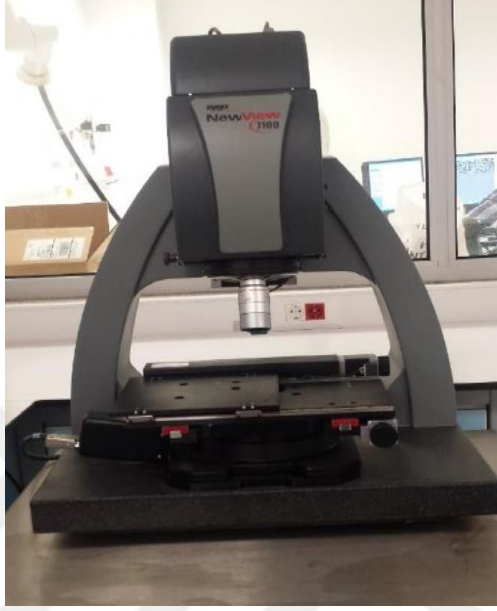
Şekil 3.11. Optik profilometre cihazı
