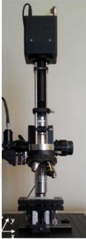
Şekil 3.3. Mikrometre boyutunda cisimlerin yüzey ölçümü için kurulan optik mikroskop (Xia ve ark. 2014)
