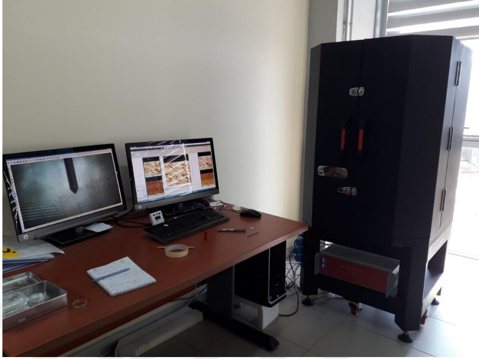
Şekil 4.10. Kırmızı kan hücrelerinin görüntülenmesi için kullanılan AFM.
